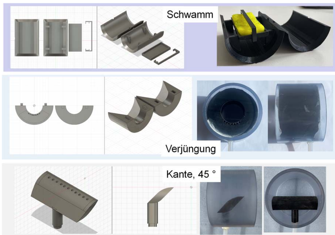
Abbildung 23 Einbaukörper Biofilm-Surrogat (Schwamm“), Unstetigkeit („Verjüngung“) sowie (Rotorblatt-)Kante
