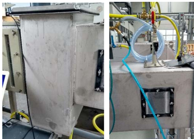
Abbildung 13 Technikumsanlage: Einbaumöglichkeit Tropfenabscheider und Einbaukörper (links) sowie Wassereindüsung (rechts)
