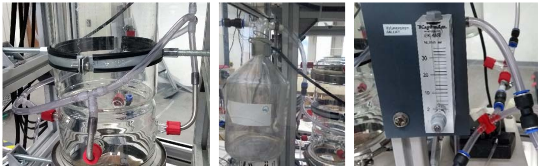
Abbildung 5 Abluftführung Glasanlage, Tropfenfang und Rotameter zur Kontrolle des Gasvolumenstroms
