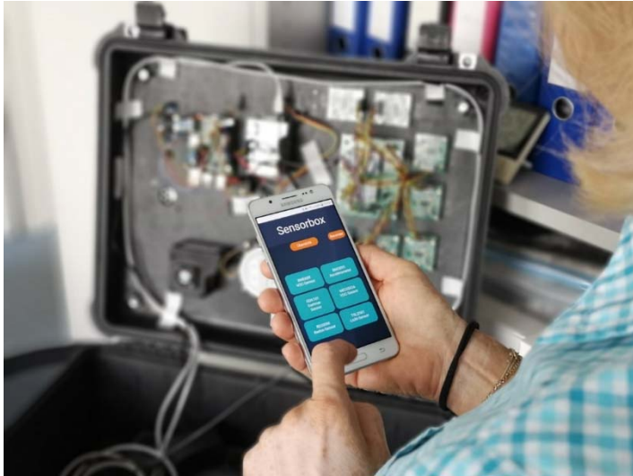
Abb. 1: Messkoffer und Datenausgabe über Smartphone
