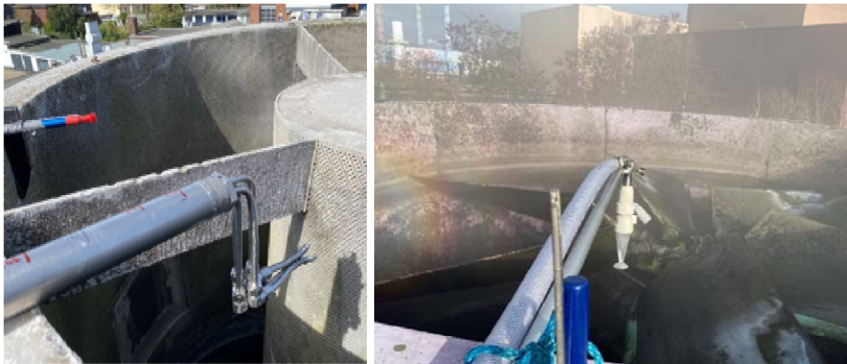
Abb. 2: Bild links: Geschwindigkeitsmessung mittels X-Pitot-Sonde (Bildvordergrund) zur Ermittlung der Hauptströmungsrichtung. Bild rechts: Erfassung des Bioaerosols mittels Zyklonsammler mit entgegen der Hautströmung ausgerichteter Absaugöffnung des Sammlers (isoaxiale Ausrichtung)
