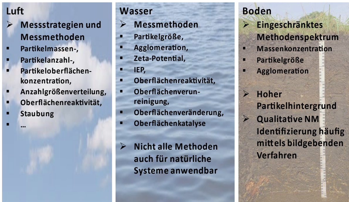
Abbildung 1: Übersicht der Parameter, die mit den zur Verfügung stehenden Messmethoden in den verschiedenen Kompartimenten bestimmt werden können.
