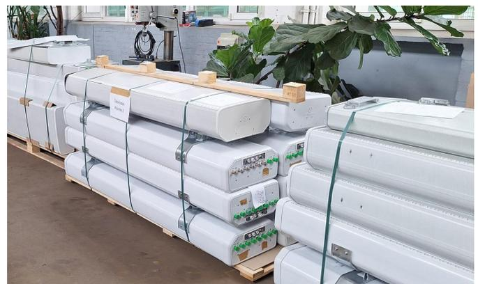
Gehäuse von Mobilfunkantennen aus GFK
