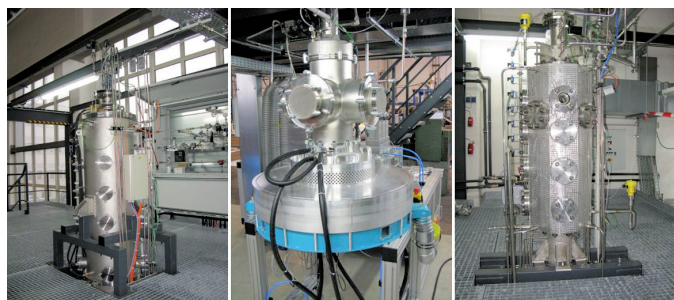
Nanopartikelsynthesereaktoren am IUTA (v. l.): Heißwandreaktor, Plasmareaktor und Flammreaktor
