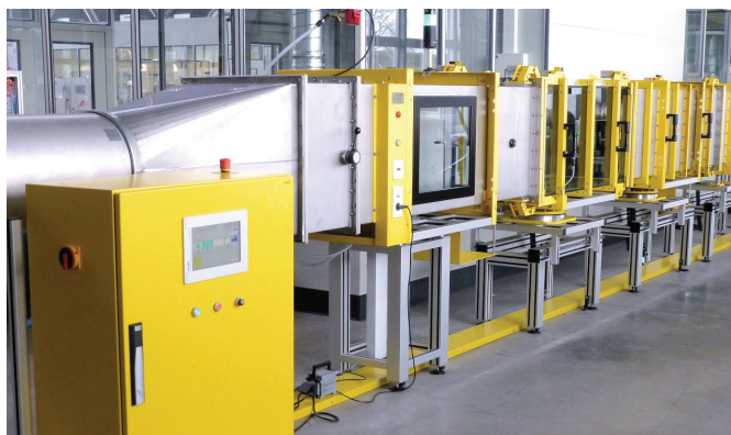
Prüfstand für Messungen nach EN 779 und ISO 16890 in der Halle 5 des IUTA
