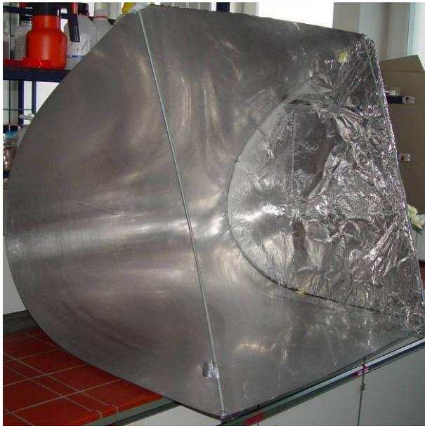
Abb. 3.4.9: Geometrie Testfläche, Zylindermantel-Teilfläche (Breite: 1 m, Länge: 2 m)
