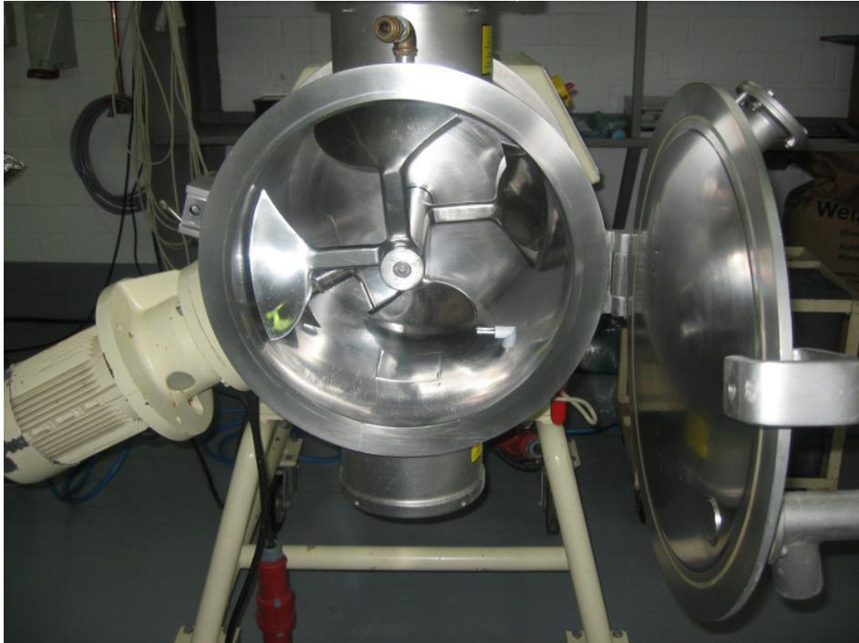
Abb. 3.6.1: Pflugscharmischer mit integriertem Agglomeratzerstörer
