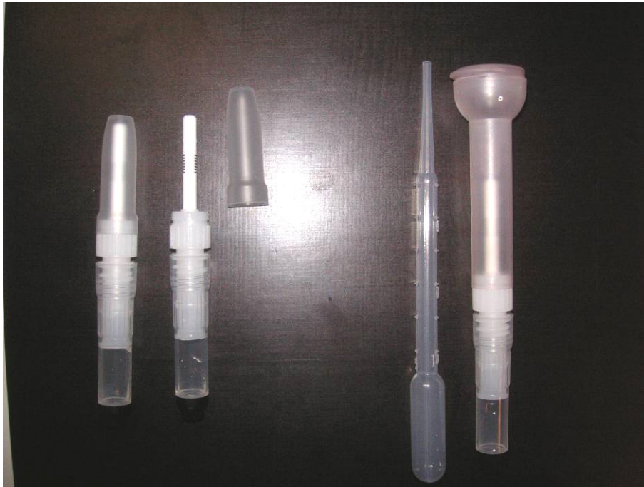
Bild 23: Optimierter HyLite plus-Pen (rechts) im Vergleich zum Standard-HyLite-Pen (links)
