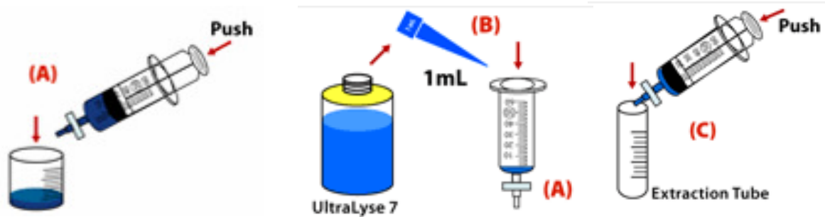
Bild 5: Probenvorbereitung zur Messung mit dem Laborgerät (Luminometer)
