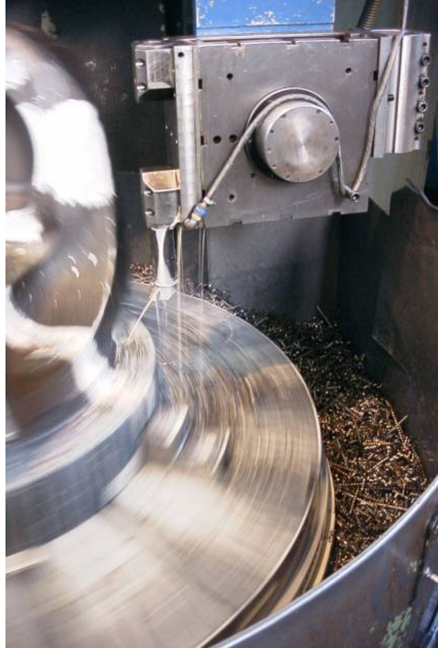
Mechanische Bearbeitung mit Emulsion
