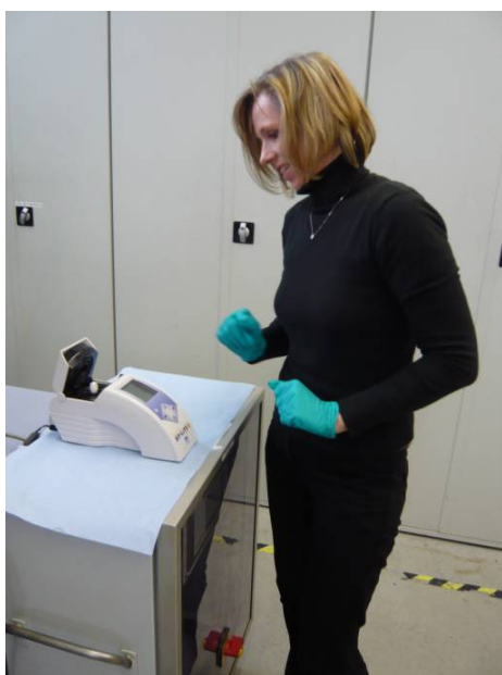
Bild 15: ATP-Messung in Proben aus der BFI-Laborversuchsanlage mit dem Hygiene-Überwachungssystem
