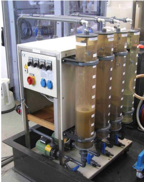
Bild 14: BFI-Laborversuchsanlage zur Alterung von Emulsionen und Kühlwässern mit Proben
