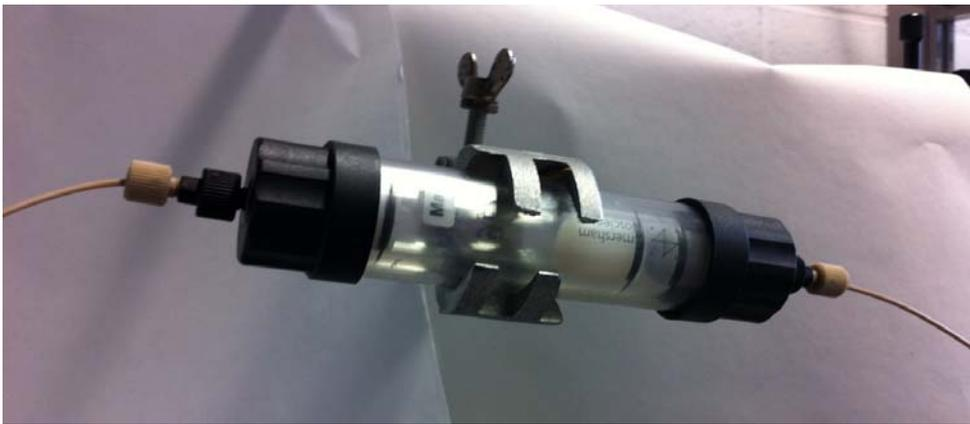
Abbildung 2-32: Vorlagegefäß „Superloop“ zur Bereitstellung von Enzym- oder Substratlösung im kontinuierlichen Mischsystem. Die Lösungen werden mittels HPLC-Pumpen gefördert.
