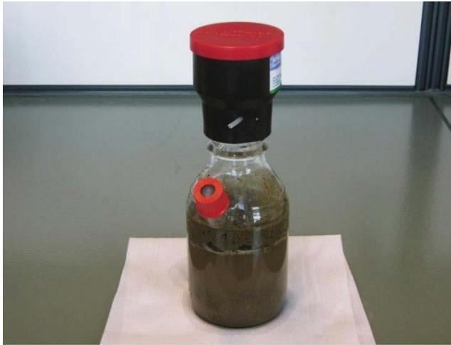
Abbildung 5: Reaktionsgefäß mit Seitenstutzen und Septum
