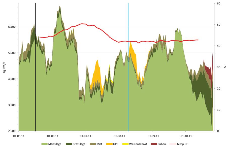
Abbildung 34: Fütterungsplan der Anlage G-11 und Verlauf der Temperatur des Hauptfermenters
