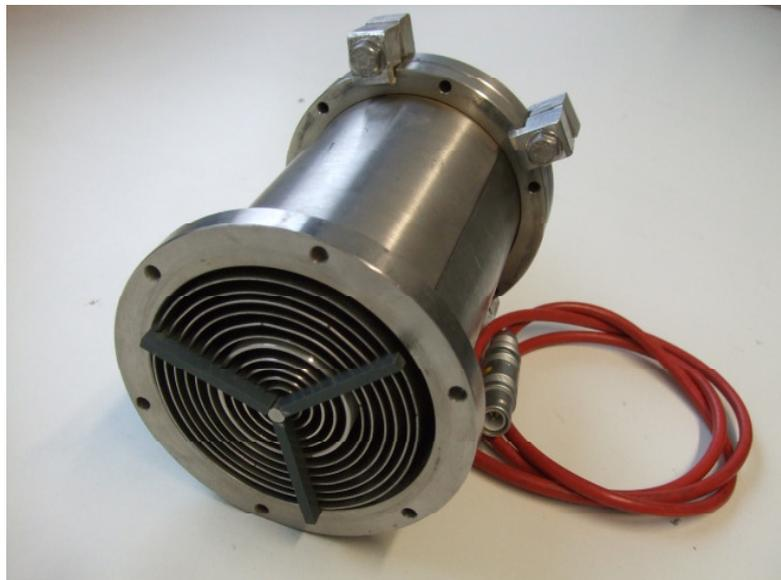
**Abb. 6.13: Elektroabscheider-Konstruktion / Vorstadium**
