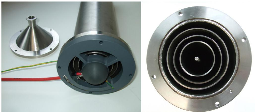
Abb. 6.2: E-Abscheider / teildemontierter Zustand
