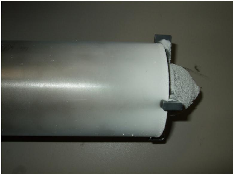
**Abb. 6.14: E-Abscheider nach Verwendung von NaCl (ohne Mantelelektrode)**
