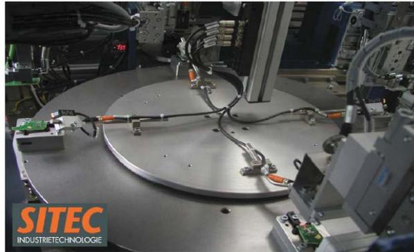
**Abbildung 50:** Beispiel eines Rundtakttisches, Quelle: Fa. SITEC (Mitglied des PA)
