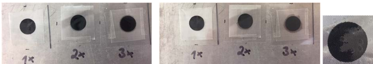
Abbildung 98: Druckschicht nass (links), getrocknet (Mitte) und vergrößert (rechts)
