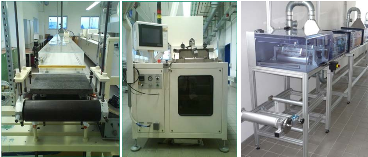
Abbildung 7: Links: Diskontinuierliche Gießanlage, Bandgeschwindigkeit 0,1 - 0,4 m/min, 12,8 m Länge, Dosierung über Schwerkraft, Schichtdicken 30 \mu\text{m} - 1,5 mm; Mitte: Kontinuierliche Gießanlage, Fa. KEKO/ Slowenien, Bandgeschwindigkeit 0,1 - 3 m/min, Länge 10,5m, Dosierung über Schwerkraft oder Druck, Schichtdicken \sim 20 \mu\text{m} – 500 \mu\text{m} ; Rechts: Laborcoater, Fa. KMS, Dresden, Bandgeschwindigkeit 0,1 – 10 m/min, Länge 6 m, Dosierung über Druckvorratsbehälter oder über Schwerkraft, realisierbare Schichtdicken 20 \mu\text{m} – 500 \mu\text{m} , Gießen mit Gießkasten oder auf Rolle
