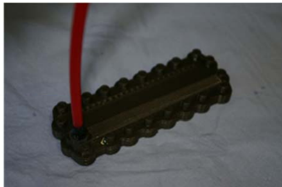
Abbildung 3-14: Links) CAD Modell; rechts) realisierter Druckluftadapter für die Kathode
