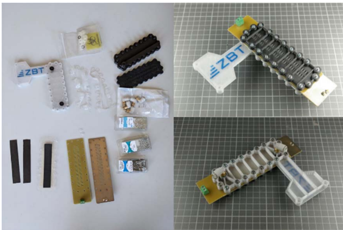
Abbildung 3-15: Links) einzelne Bauteile der passiven PEMFC; rechts) fertig montierte passive PEMFC - Ansicht von Kathoden- bzw. Anodenseite
