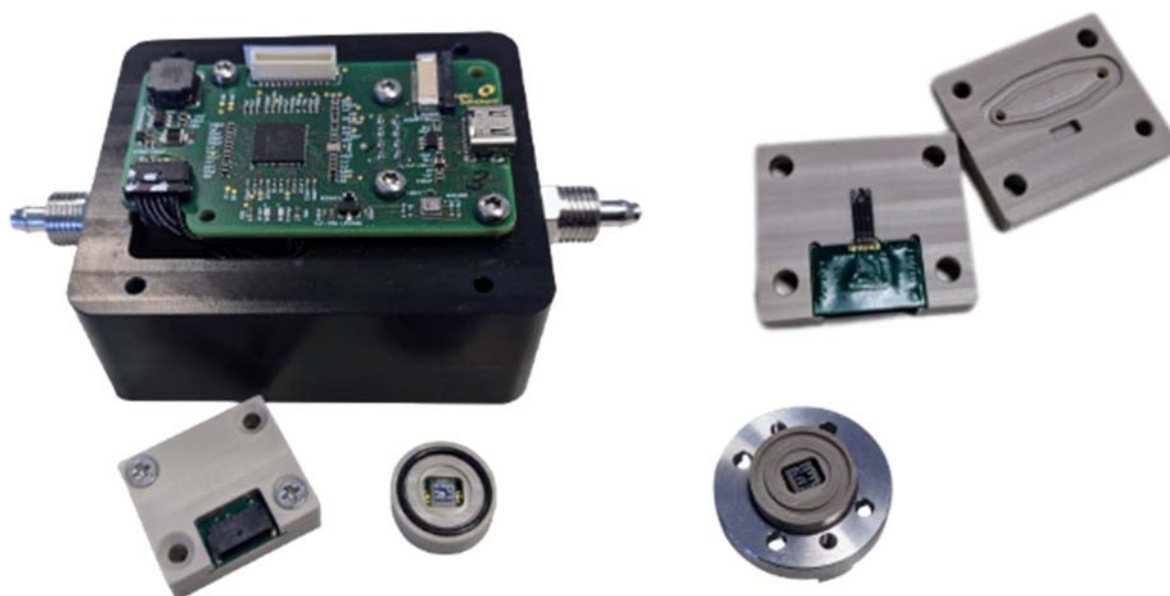
Abbildung 4-31: SAFEREF-Demonstrator ohne aufgesetztem Deckel (eloxierter Alu-Rahmen mit TFT-Display). Auch wenn das Display nicht gesteckt ist, kann der Demonstrator vollständig über USB mit einem PC Daten austauschen. Im linken Bild unten sind die beiden Sensor-Module für Flow und Gas zu erkennen, auf der rechten Seite oben das geöffnete Flow-Sensor-Modul und rechts unten das Gas-Sensor-Modul eingelegt in den Adapterring, ohne O-Ring und PTFE-Membran.
