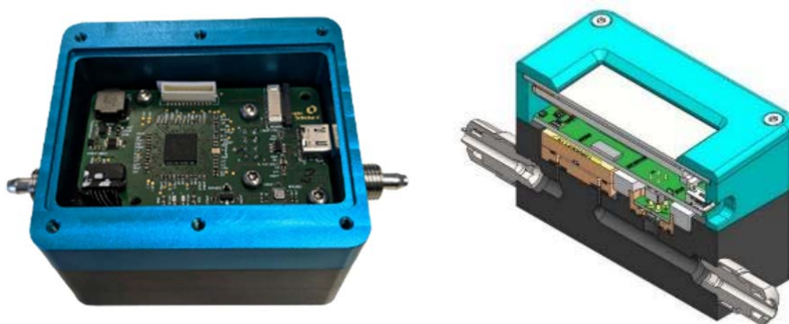
Abbildung 4-33: SAFEREF-Demonstrator mit entferntem Display (links) und Gesamtsystem in Querschnitts-Darstellung (rechts). Links unten auf der Hauptplatine befindet sich der 7-polige Stecker zum Flow-Sensor-Modul, links oben werden die 24V für den TFT Display-Treiber erzeugt. Oberhalb vom PSoC 5 befindet sich der Stecker für Programmier-Interface und Debugging des embedded Systems, rechts neben dem PSoC 5 mittig das 2x4 Pogo-Pin Array zum Gas-Sensor-Modul. Die Buchse
