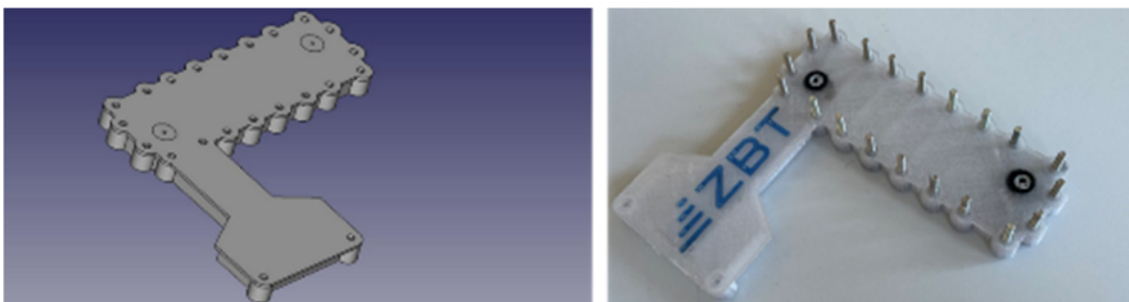
Abbildung 3-11: Links) CAD Modell der Anoden-Andruckplatte der einzelnen PEMFC; rechts) 3D gedruckte Anoden Anpressplatte mit eingesetzten Schrauben bzw. Zugankern und eingelegten Dichtringe
