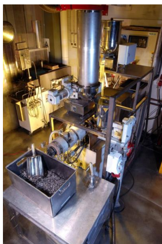
Abbildung 8: Verwendete Geräte in der Compoundherstellung und Verarbeitung. Extruder PTW25/36p (links) und Spritzgießmaschine Boy E HV 35 (rechts).
