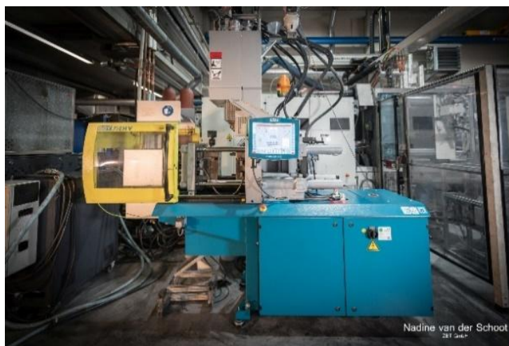
Abbildung 8: Verwendete Geräte in der Compoundherstellung und Verarbeitung. Extruder PTW25/36p (links) und Spritzgießmaschine Boy E HV 35 (rechts).
