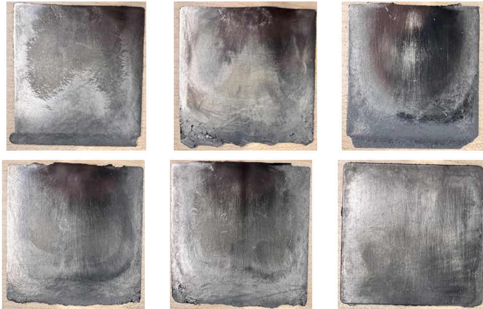
Abbildung 9: Im Spritzguss hergestellte Probekörper der Compounds zur Untersuchung der nachhaltigen Polymere – „Referenz“, „Blend-PE“, „HDPE“ (obere Reihe, von links nach rechts) und „PA6.10“, „PA11“, „PP“ (untere Reihe, von links nach rechts). Die Angussseite der Probekörper ist im Bild oben.
