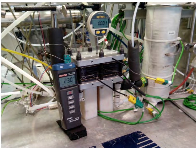
Abbildung 2.32 Messaufbau für die thermische Ausdehnung
