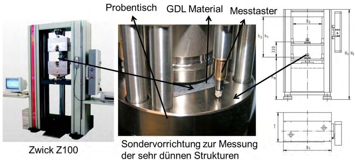
Abb. 2.1 Die Zugprüfmaschine Zwick Z100 und die Sondervorrichtung für Kompressionsversuche von sehr dünnen Strukturen
