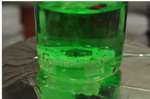
**Abbildung B4** Stromlose Nickelabscheidung auf versintertem Nanosilizium (hier Testphase an einem Bruchstück)
