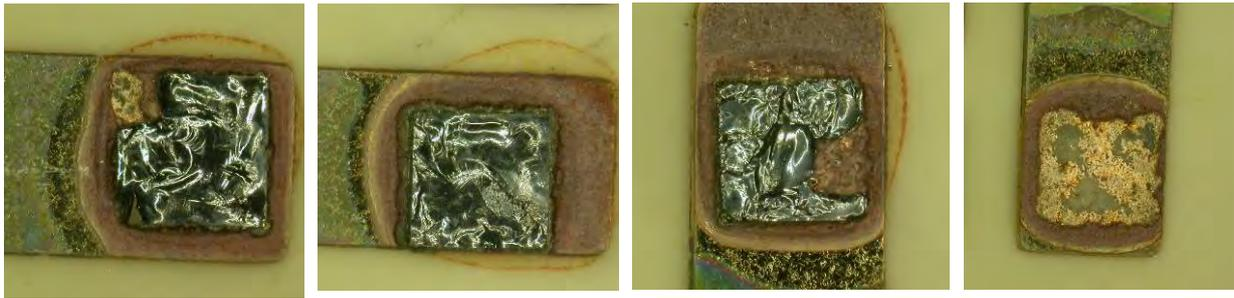
**Abbildung C14** Bruchflächen nach dem Scherversuch, Lot CuP284-Paste
