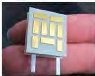
Thermoelektrischer Generator aus Nano-Silizium © AIF
