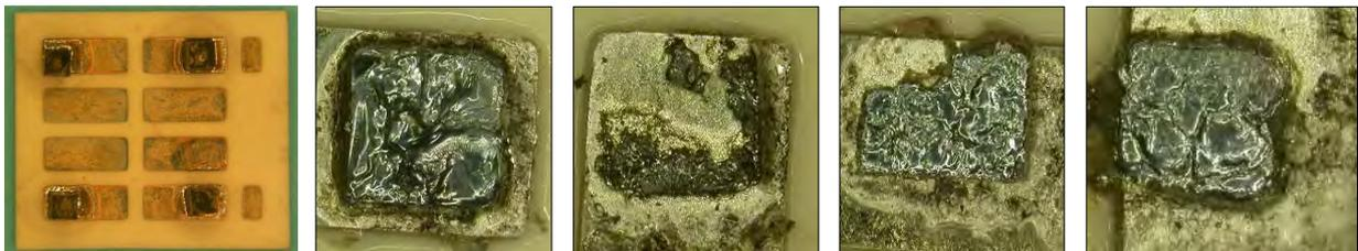
**Abbildung C11** Scherprobe mit 4 Thermoelktroden und Bruchflächen nach dem Scherversuch, Lot Ag156-Paste
