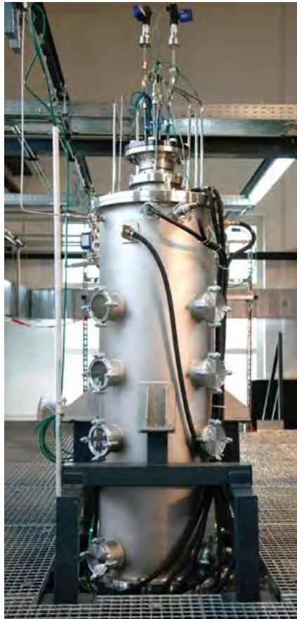
**Abbildung A3** In der Pilotanlage montierter Heißwandreaktor. Mehrere Öffnungen ermöglichen optische in-situ Diagnose in der heißen Reaktionszone und der oben angebrachten Düse.
