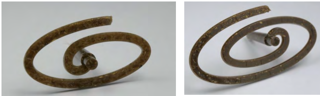
Abbildung 19 – Fließspiralen aus PLA-Flachs-Compound: vor (links) und nach (rechts) der Optimierung der Prozessparameter.
