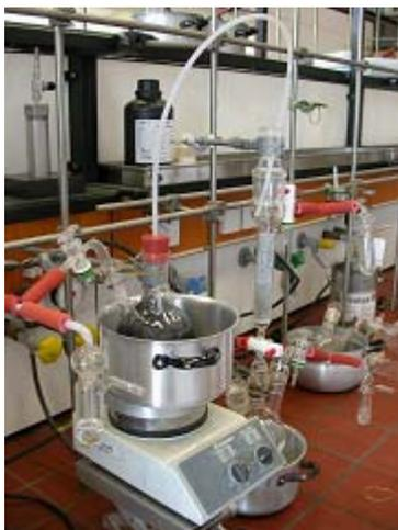
**Abbildung 81:** Glasapparatur zur Visualisierung der Suspension
