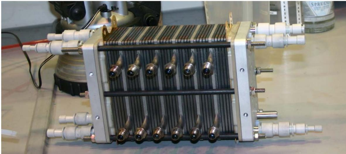
**Abbildung 6:** Verspannter HT-PEM Stack
