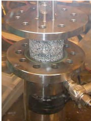
**Abbildung 80:** Grobporiger Aluminiumschaum in Reaktor II
