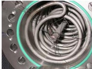
**Abbildung 78:** Einbau des Sintermetallrohres
