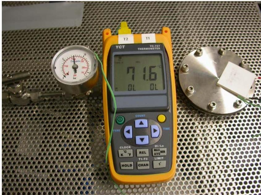
**Abbildung 72:** Temperaturmessung und Dichtheitstest am Probenbehälter
