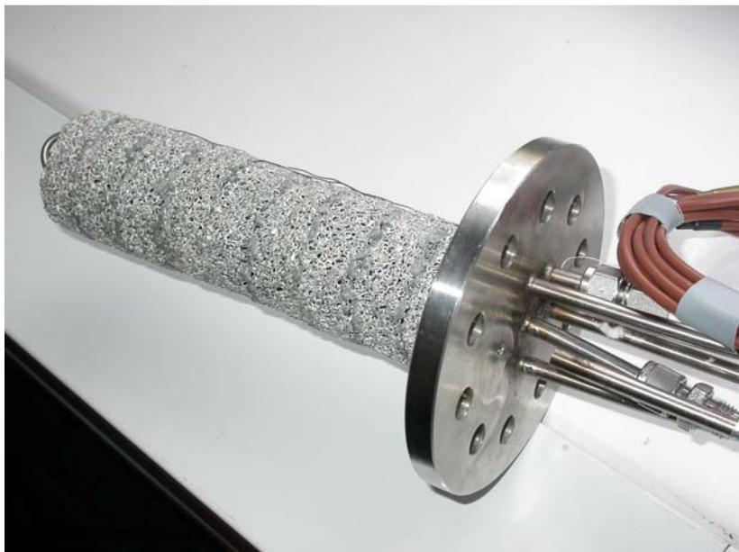
**Abbildung 24:** Zusammengefügte Schaumscheiben mit Deckelanschlüssen
