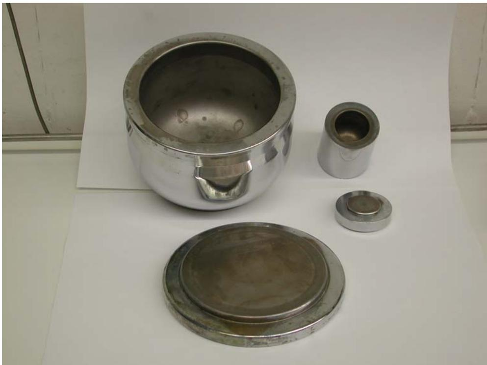
**Abbildung 75:** Größenvergleich von Mahlbechern für Ansätze im 100 g Bereich und im Labormaßstab (bis ca. 5 g)
