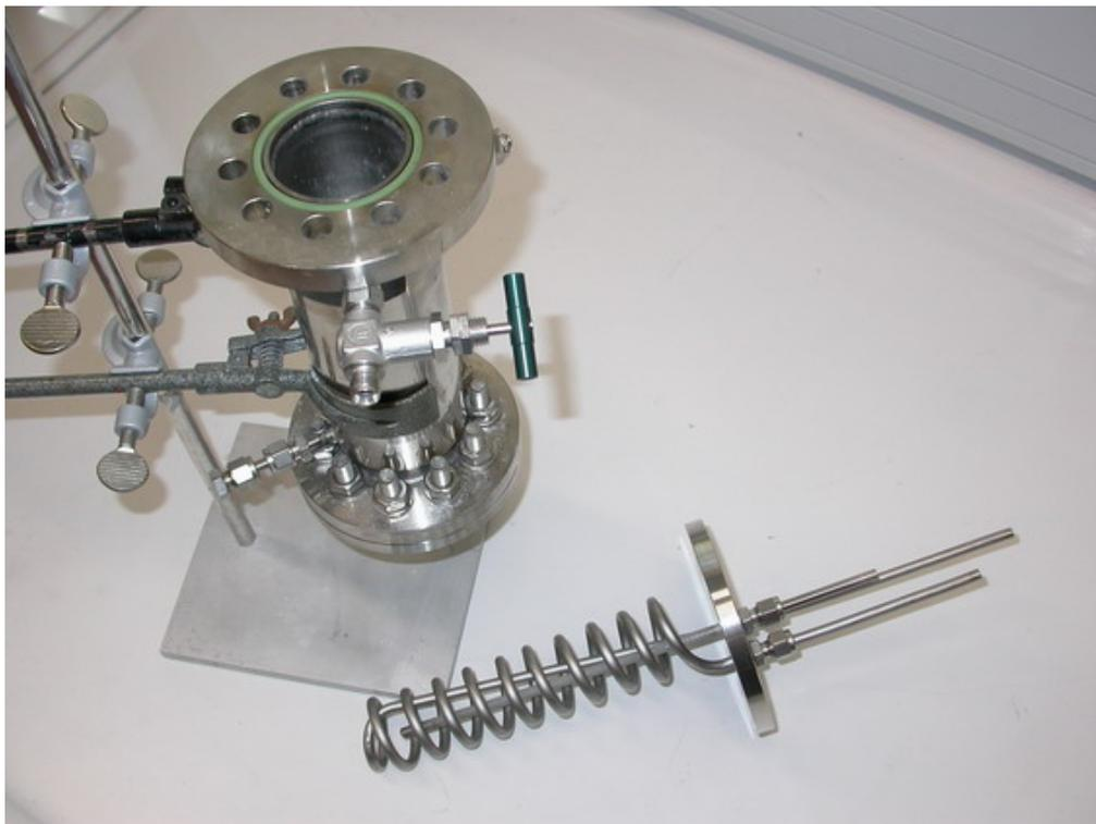
Abbildung 57: Prototyp II mit Rohrwendeleinsatz
