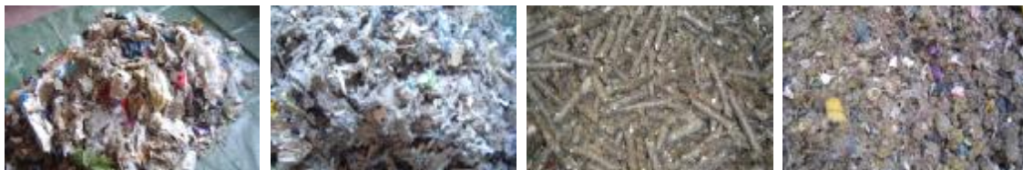
Abbildung 5: Ersatzbrennstoffe (v.l.n.r) –Hochkalorik MBA, Mittelkalorik MBA und zwei Stabilate aus einer MPS in Pellet- und Fluffform
