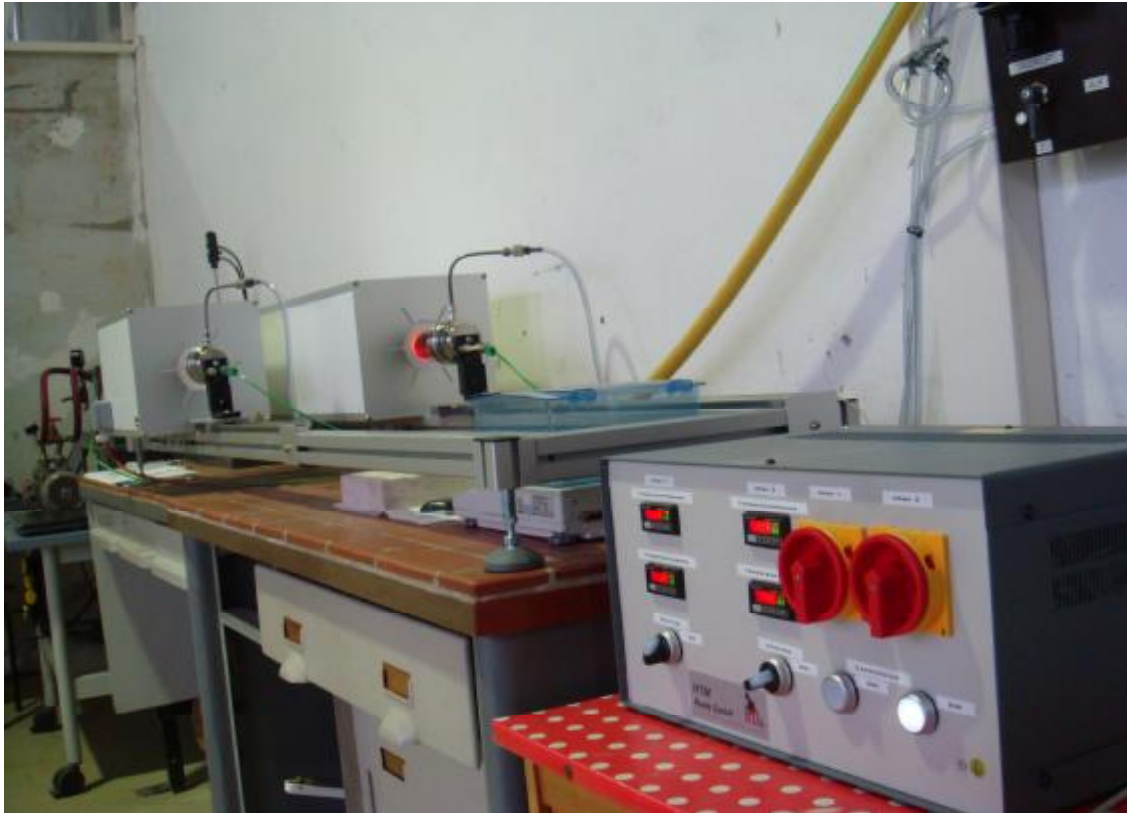
Abbildung 22: Steuereinheit (Vordergrund) sowie Ofeneinheit des Demonstrators (Hintergrund)
