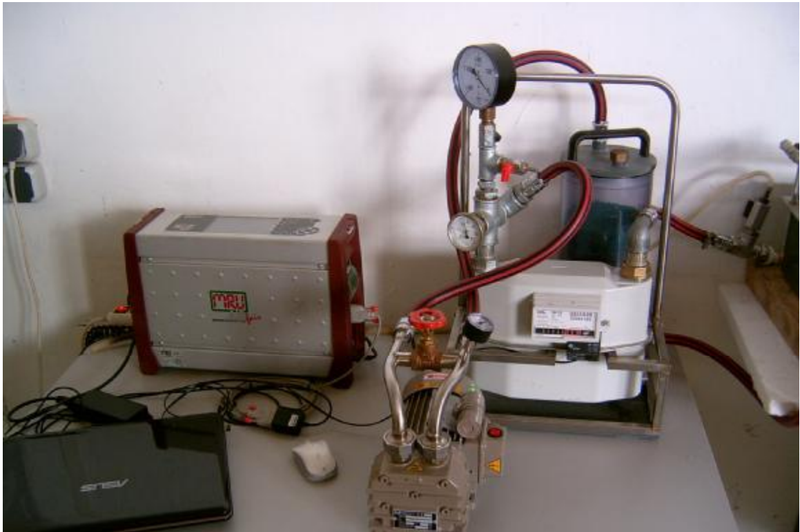
Abbildung 26: Abgasweg des Demonstrators mit Rauchgastrocknung, -volumenmessung sowie -analyse
