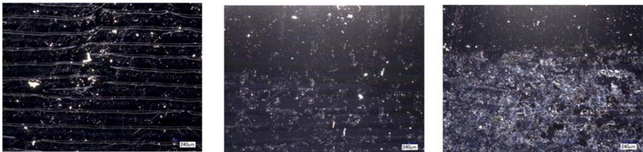
**Abb. 19:** Plasma-Ätzen von Ionomer auf Silizium Wafer. Optische Mikroskopieaufnahmen von (a) unbehandelt, (b) O<sub>2</sub>:Ar, 300W, 1 min und (c) Ar, 300W, 1min
