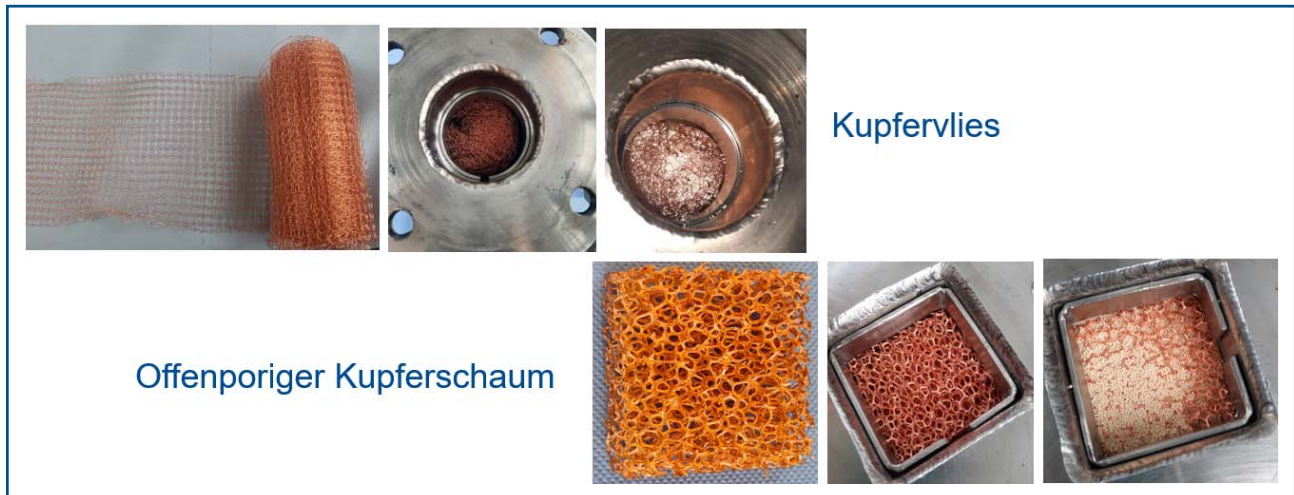
Abbildung 2: Reaktoren mit kreisförmigen und quadratischen Querschnitten und thermisch leitfähigen Reaktoreinbauten
