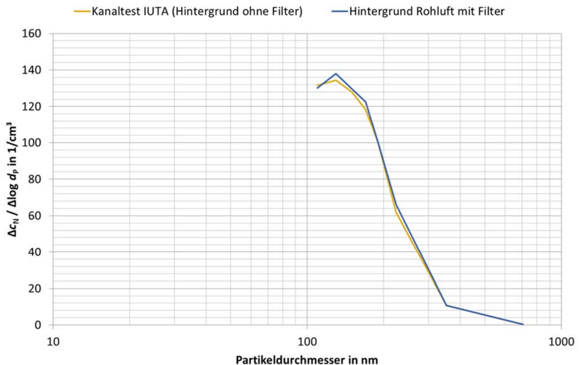
Abbildung 1-31: Anzahlverteilungsdichte bei Hintergrundmessung am IUTA-Prüfkanal
