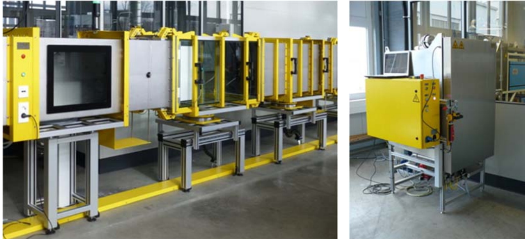
Abbildung 1-24: Filterprüfstand und Konditionierungskabinett an der FE2
