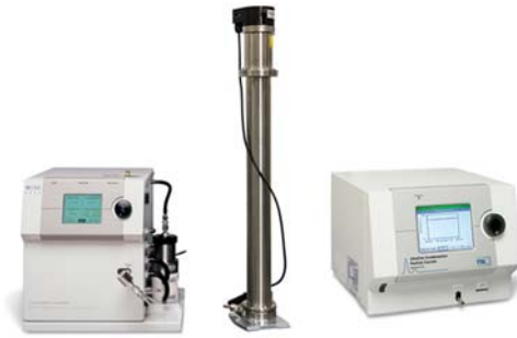
Abbildung 1-26: SMPS-System TSI (3080/3081 + CPC 3776) (Bildquelle: www.tsi.com )
