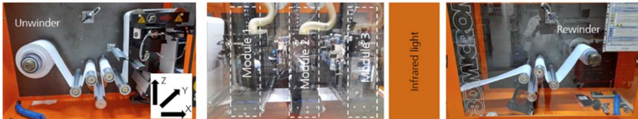
Abbildung 25: Modulares R2R-System am Fraunhofer ENAS, gespeist mit Rollenpapier.
