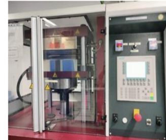
Abbildung 24: Heißpressverfahren am ZBT
