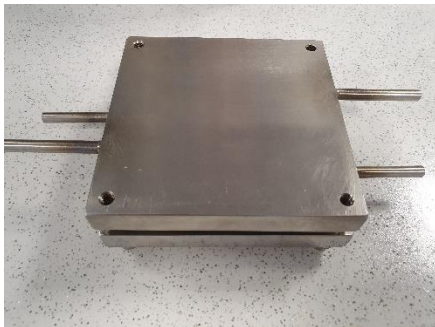
Abbildung 3: Foto sowie Schema des Metallplattenaufbaus zur Herstellung von funktionsbereiten Festsäurebrennstoffzellen in einem einstufigen pressverfahren. Zwischen den dargestellten Metallplatten incl. integriertem Flowfield werden die GDE (Gasdiffusionselektroden) sowie die CsH 2 PO 4 Membran platziert.
