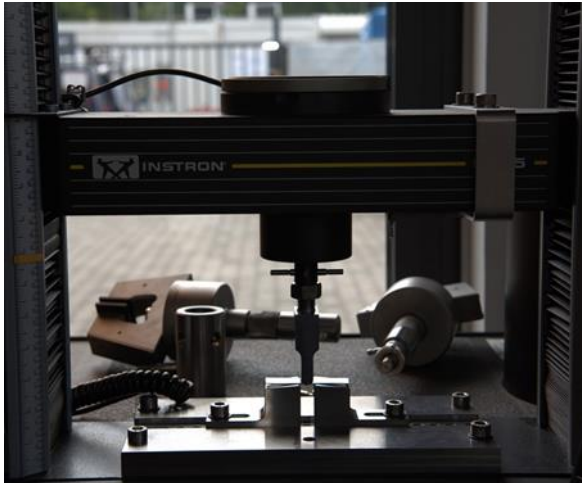
Abbildung 34: (Links): 3-Punkt-Biegespannungsmessgerät; (Rechts): Versuch mit verstärkter Membran
