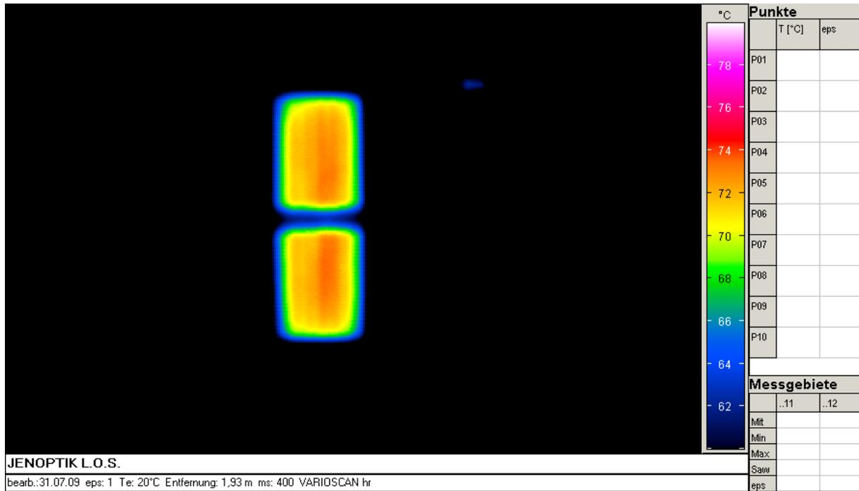
**Abbildung 4.40:** Wärmebild Porenschaum bei 800 mA/cm<sup>2</sup>
