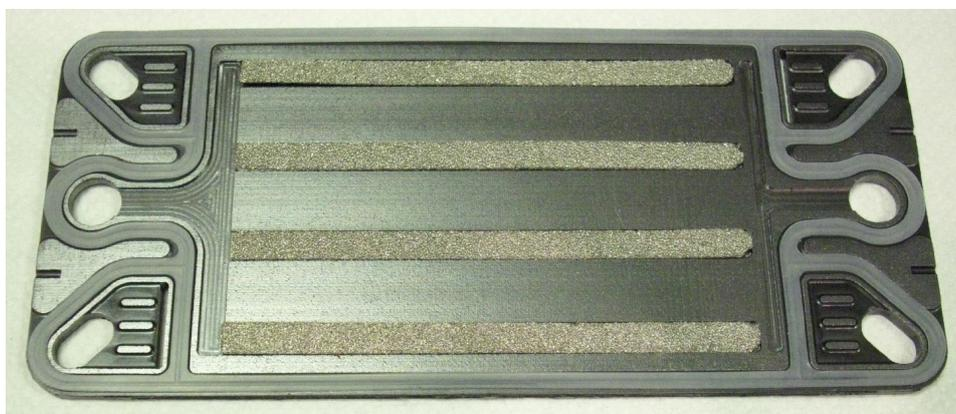
**Abbildung 4.38:** Verdampfungskanäle mit Porenschaum
