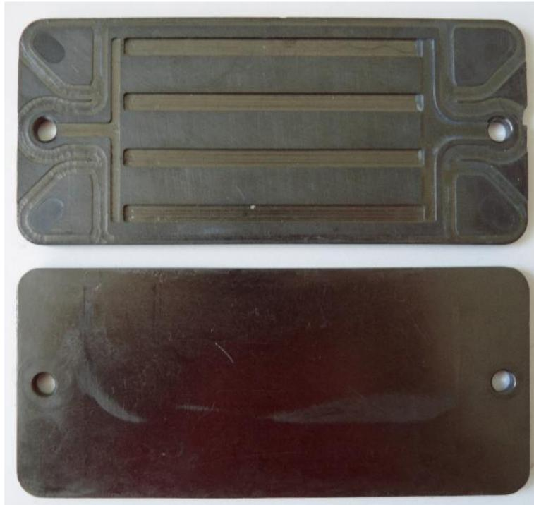
**Abbildung 3.8:** Bipolarhalbplatte der ersten Generation
