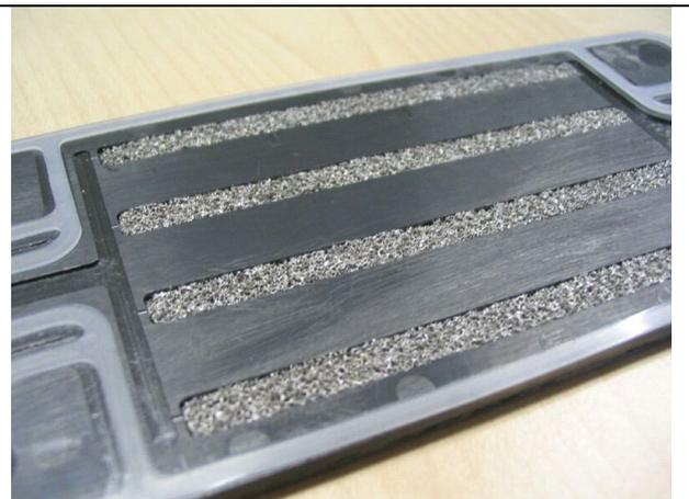
**Abbildung 4.8:** Compoundplatte mit vier eingelegten Streifen aus einem Nickelschaum und aufgelegter Dichtung
