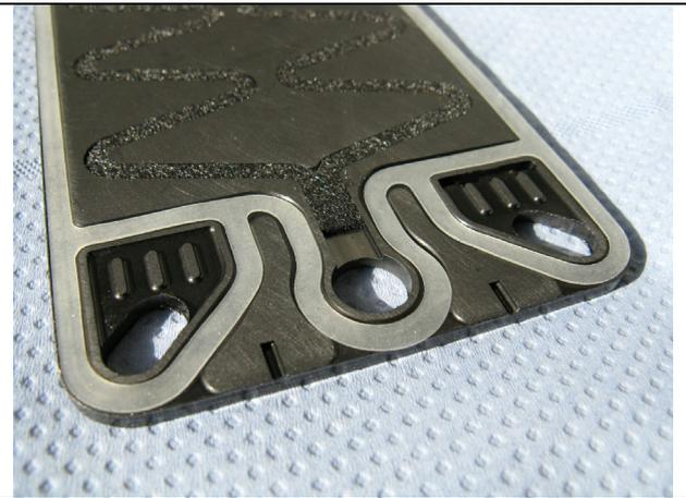
**Abbildung 4.10:** Einlassbereich der Versuchsplatte mit eingelegtem Porenkörper und platzierter Dichtung
