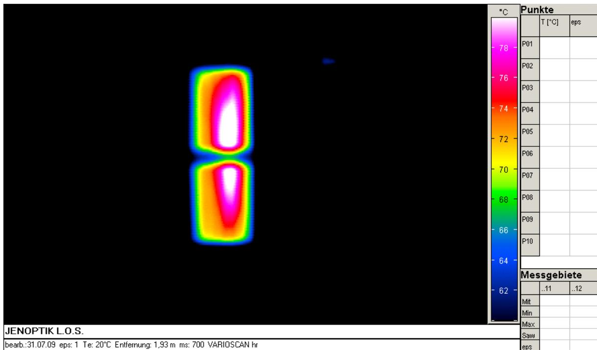
**Abbildung 4.41:** Wärmebild Porenschaum bei 900 mA/cm<sup>2</sup>
