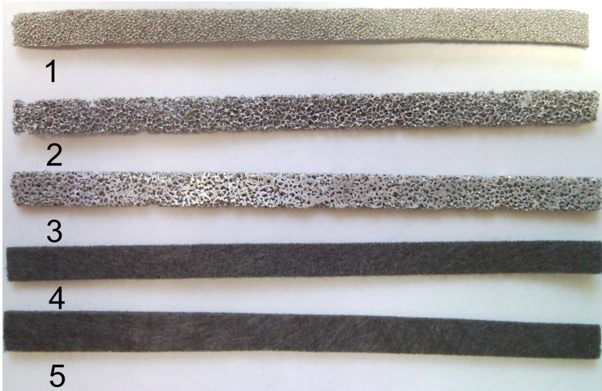
**Abbildung 3.7:** Für die Verdampfungskühlung vorgesehene poröse Materialien
