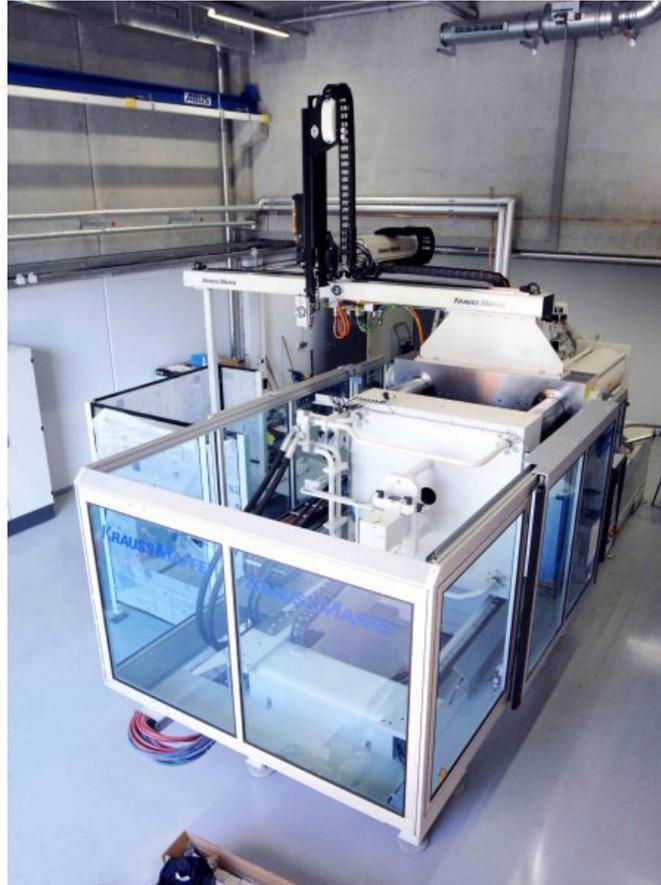
**Abbildung 4.17:** Spritzgießmaschine KM500 mit Linearroboter LR 150
