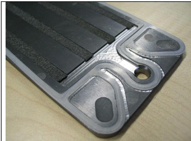
**Abbildung 4.7:** Compound-Platte mit eingelegten GDL-Filzen und aufgelegter Dichtung
