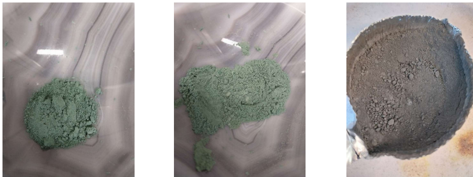
Abbildung 20: Verarbeitung des sulfidierten VOx-Materialien, welches mittels PiL-Verfahren hergestellt wird; links) Ausgangsmaterial nach dem PiL-Verfahren am INP; mitte) mittels Mörser zerkleinerte VOx-Materialien; rechts) getempertes VOx-Material nach 2 .
