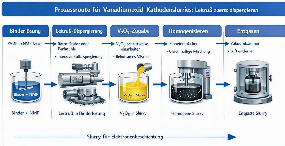
Abbildung 19: Prozessschema der Slurryherstellung für Vanadiumoxid-Kathoden: Leitruß-Dispergierung vor schrittweiser V 2 O 5 -Einarbeitung.
