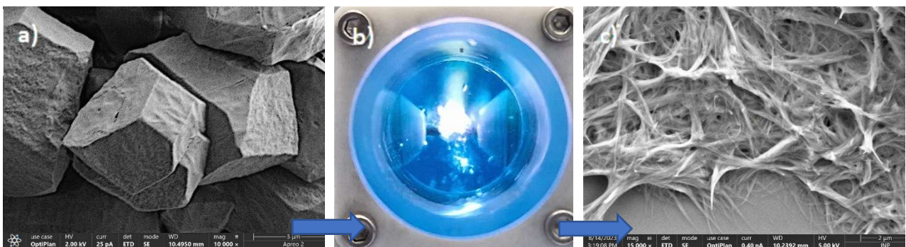
Abbildung 9: PiL-Prozess von \text{VOSO}_4 in wässrigem Präkursor. SEM-Aufnahme des mikrokristallinen Ausgangsstoffes, welcher in den Reaktor überführt wurde (b) und den 2-D-Nanomaterialien als Endprodukt (c).
