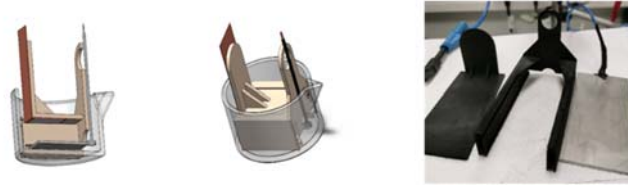
Abbildung 6 Durch 3D-Druck erzeugte EPD-Zelle zur (vertikalen) Abscheidung gegen die Sedimentationsrichtung
