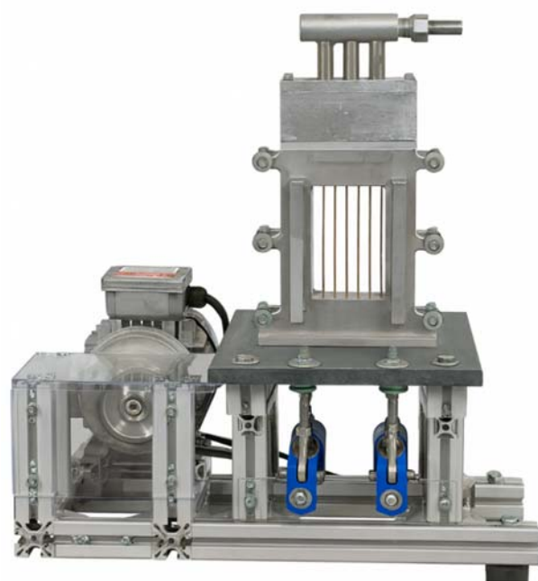
Abbildung 54: Mechanik zur Vibrationsanregung über zwei gegenläufige Wellen, auf welche Exzenter-Aufsätze aufgeschraubt werden (oben), und Gesamtaufbau der Mechanik zur Vibrationsanregung über gegenläufige Wellen mit Exzenter-Aufsätzen (blau) hier mit angebindenem Flachmedien-Filter (links)
