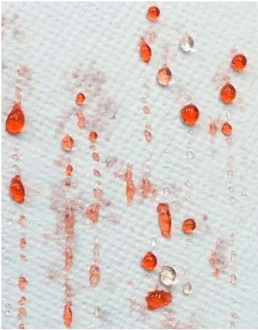
Abbildung 4: fotografische Aufnahme des Ölaustritts (hier rot eingefärbtes Öl) auf der Reingasseite eines Filters
