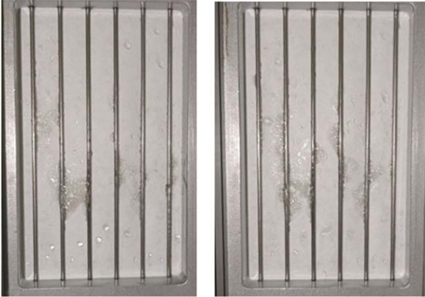
Abbildung 56: typisches Bild für die Tropfenbildung und die Öl-Schaumbildung auf der Reingasseite des Filters im Bereich der Sättigung vor und nach der Vibrationsanregung mit 55 Hz
