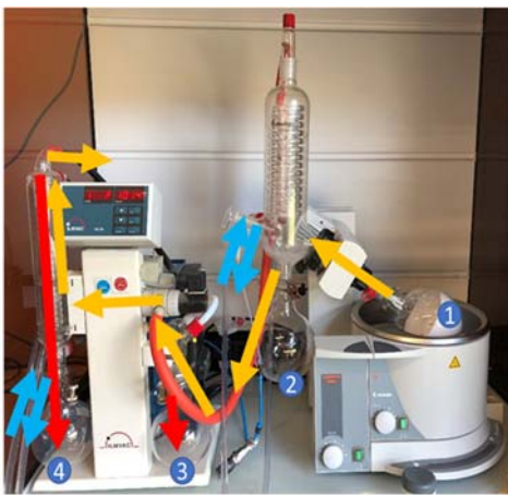
Abbildung 9 - Aufbau und Funktionsweise des Rotationsverdampfers zum Trocknen des HEA-Pulvers (orange = gasförmiges Lösungsmittel, rot = kondensiertes, flüssiges Lösungsmittel, blau = Kühlwasser) mit schematischem Trocknungsprozess des HEA-Pulvers im Rotationsverdampfer.
