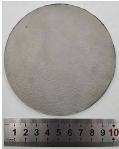
Abbildung 34 - Gesintertes HEA 1-Target mit einem Durchmesser von 100 mm und deren Dichteverteilung in absoluten und relativen Werten für beide Hochentropie-Legierungen.
