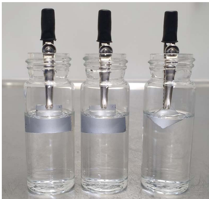
Abbildung 11 Eingespannte Aluminiumplättchen zur Beschichtung mittels T-BAG-Methode.
