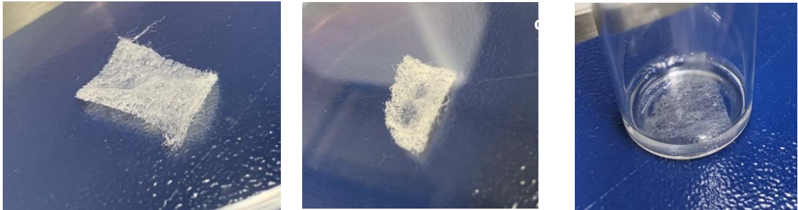
Abbildung 18 Eingesetztes Textil; a) geringes Volumen auf der Oberfläche b) benetztes Textil c) komplett in Lösung eingelegt.
