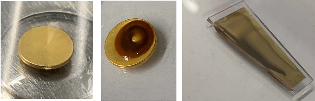
Abbildung 7 Eingesetzte Materialien mit Goldoberfläche; a) mit Piranha-Säure gereinigtes rundes Material b) Veränderung der Oberfläche während des Beschichtungsvorgangs c) goldbedampfter Objektträger mit aufgebracht Lösung der Ligandenbindestelle.
