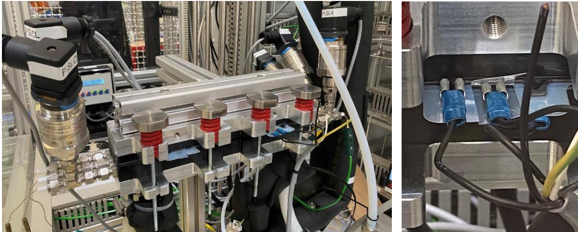
Abbildung 63: BZ-Shortstack Integration in den Teststand (links) und CVM-Anschluss über Flachstecker (rechts)
