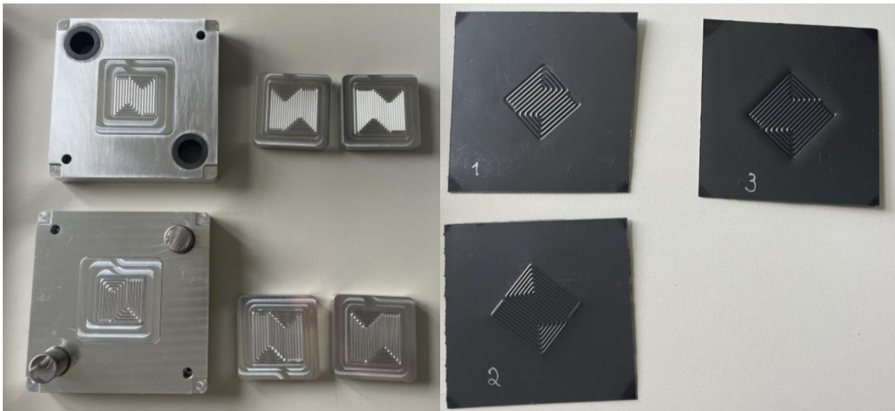
Abbildung 26: Gefertigte Prägestempel (links); mit den verschiedenen Einlegern geprägte Folien (rechts)
