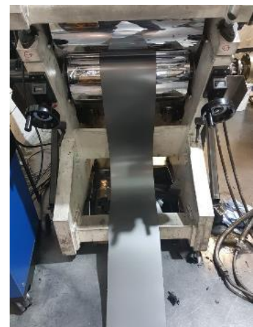
Abbildung 1: Skizze der Folienproduktionsanlage mit Kalandrierer, Breitschlitzdüse und Einschneckenextruder (links), sowie austretende Compoundfolie nach Durchlaufen des Kalandriers
