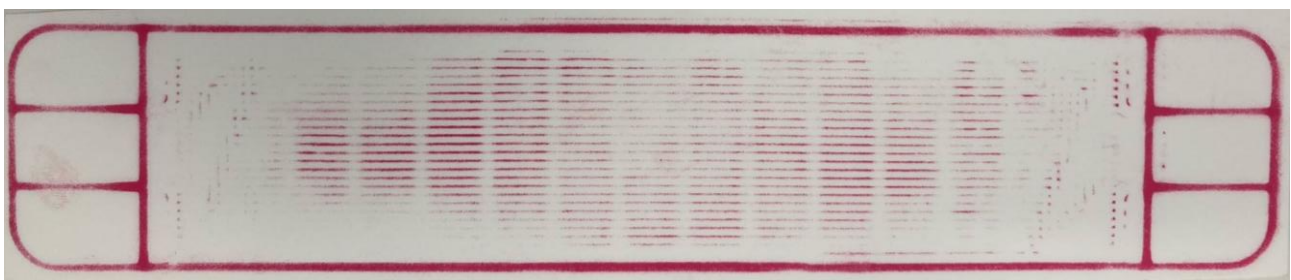
Abbildung 66: Kraftabdrücke der 100 cm 2 Folie bei 9kN Anpresskraft: a) Zwischen BPP Randplatte und Medienverteiler/Stromabnehmer; b) Zwischen benachbarten BPP (BPP jeweils aus „Anoden“ und „Kathoden“ Design)
