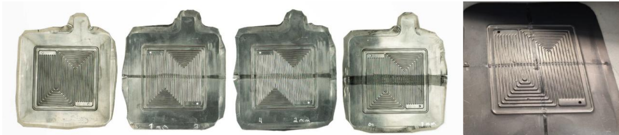
Abbildung 20: Geprägte Folien ohne Fasertape, mit unterschiedlich breiten Fasertapes und über Kreuz verarbeitetes Tape
