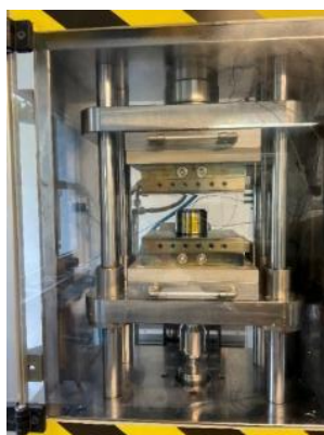
Abbildung 3: Variothermer Pressprozess (links) Beispielhafte Prozessparameter jeweils mit eingestellt und gemessenem Druck bzw. Temperatur (rechts)
