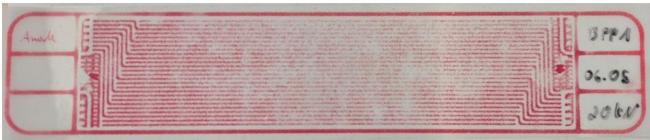
Abbildung 61: Kraftabdruck bei 20 kN Anpresskraft zwischen BPHP und MEA
