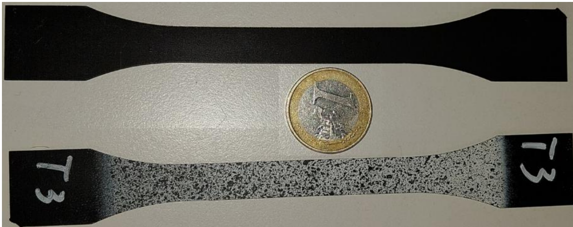
Abbildung 15: Oben: Maße des verwendeten Zugprobekörpertyps 1B (DIN EN ISO 527-2), unten: geschnittene Probe inkl. Lackmuster.
