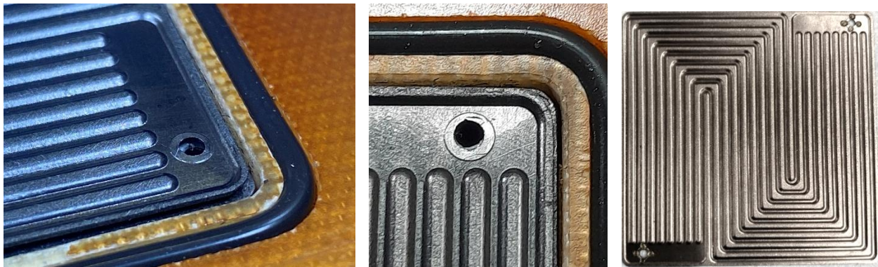
Abbildung 54: Anode im Rahmenelement vor Testung (links), nach Testung mit Bruch (mitte), mit Verstärkungselementen (rechts)
