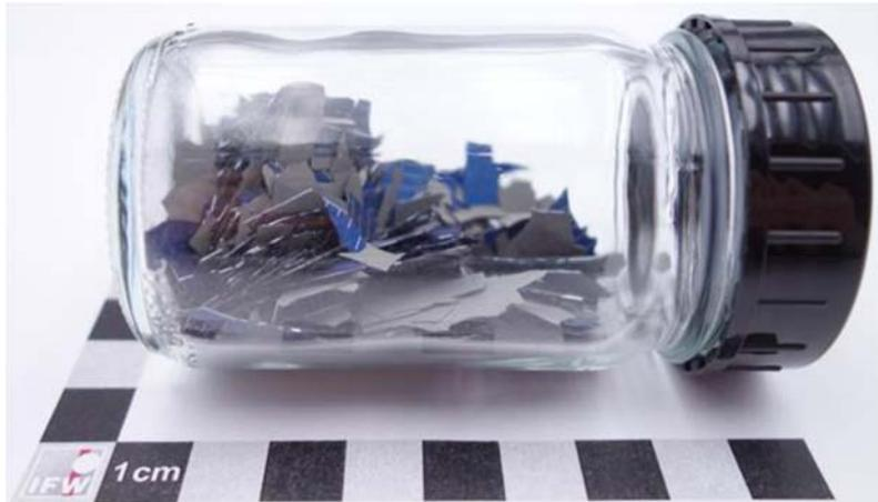
Abbildung 4: Grob zerkleinerte PV-Siliziumschicht (Mat\_3).
