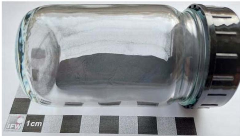
Abbildung 13: Silizium-Referenzpulver von der Firma Nanoval.
