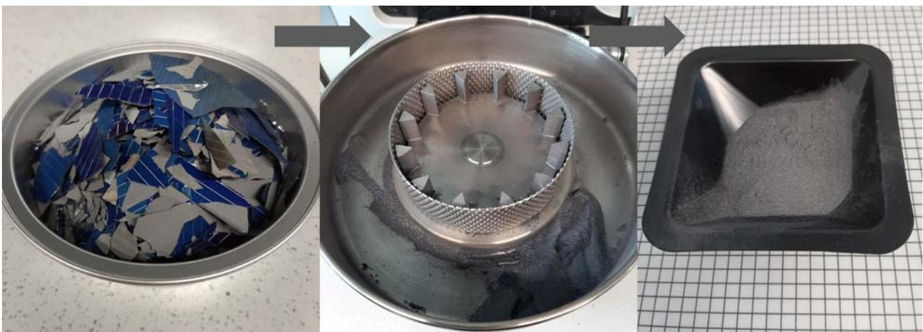
Abbildung 16: Prozesskette zur Mikronisierung von Mat\_3 beim EZD.
