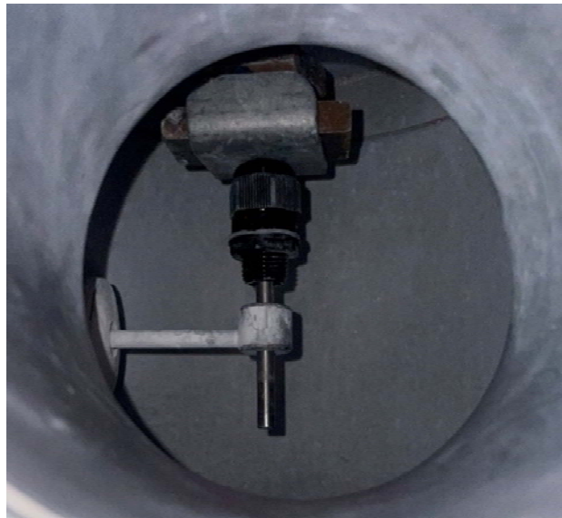
Abbildung 33: Drahtelektrode mit angebrachten Gewichten zur Schwingungsdämpfung.
