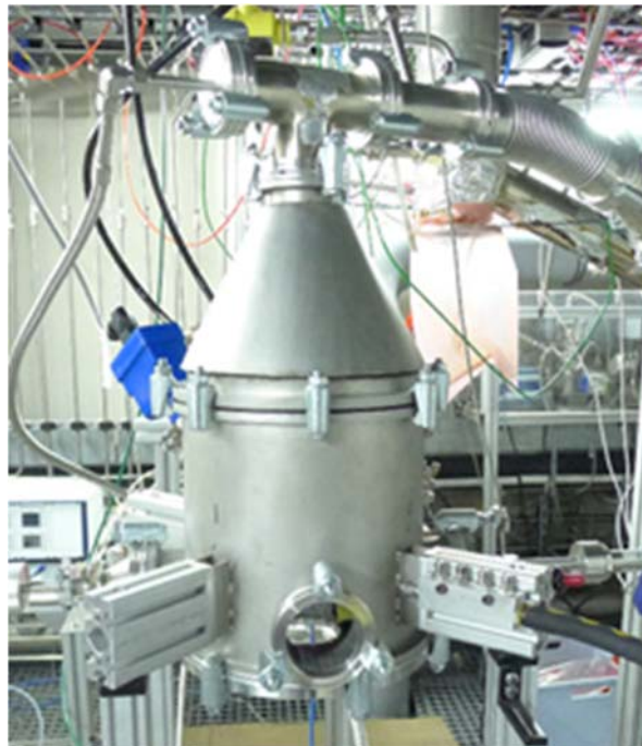
Abbildung 3: Sprühflammenreaktor im Technikum des IUTA e.V.
