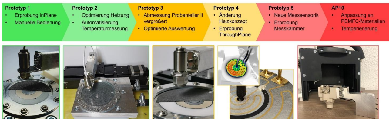
Abbildung 2: Chronologische Weiterentwicklung der Prototypen des Messgeräts
