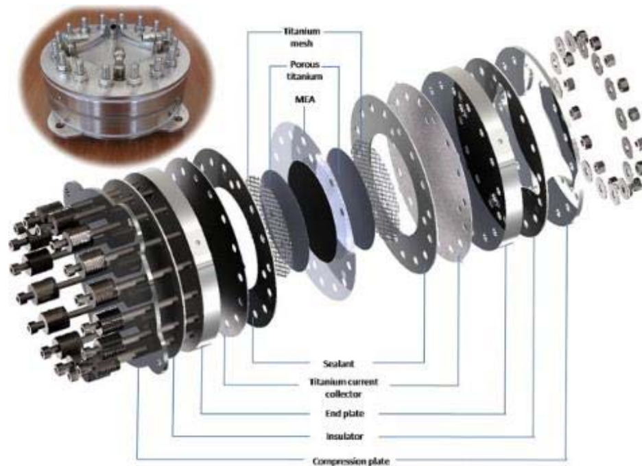
Abbildung 1: Explosionszeichnung einer PEM-Wasserelektrolyse-Zelle. [1]
