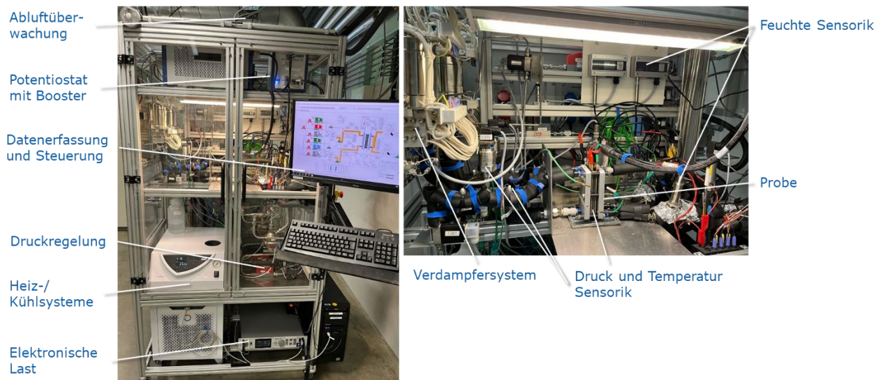
Abbildung 20: Teststandumgebung mit Darstellung der Komponenten
