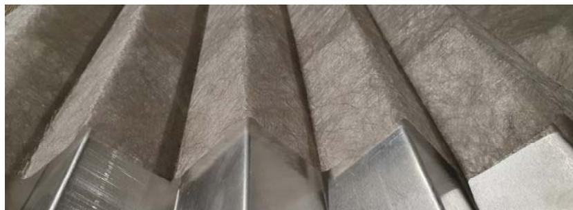
**Abbildung 33: Plissierter Tuftingträgervliesstoff**
