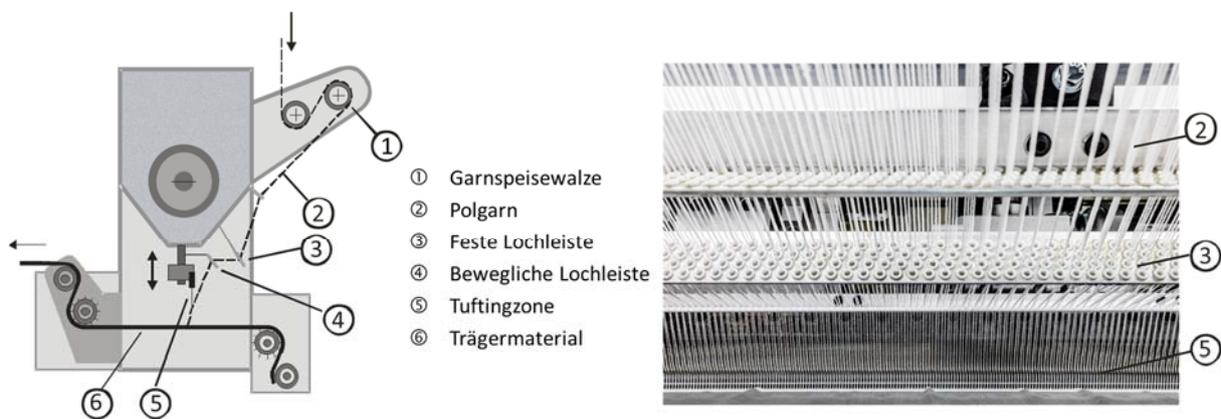
Abbildung 1: Tuftingtechnologie; links: Prinzipskizze der technologischen Elemente; rechts: Fotografie der Tuftingzone
