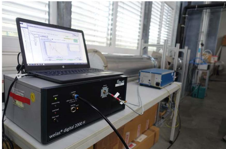
Abbildung 19: Selbstentwickelter Prüfkanal zur elektrischen Kontaktierung der getufteten Proben und Messung des Fraktionsabscheidegrads.
