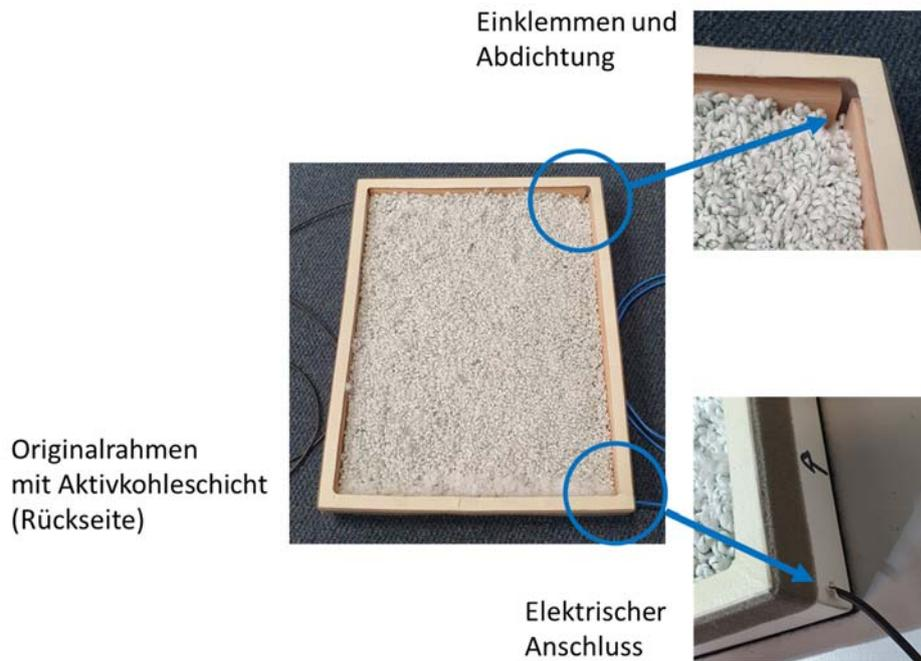
Abbildung 54: Einbau der getufteten Filterstruktur in den Originalrahmen des Raumlufreinigers für die Überprüfung der vollformatigen Filter
