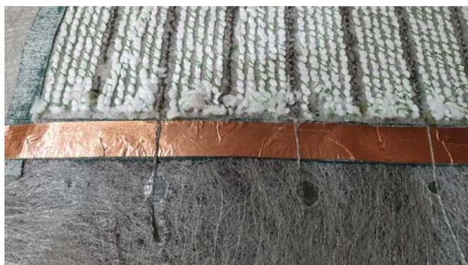
Abbildung 28: Kupferstreifen auf umlaufendem Rand auf der Rückseite des Filters
