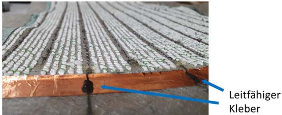
Abbildung 29: Leitfähiger Klebstoff zur Kontaktierung der leitfähigen Garne
