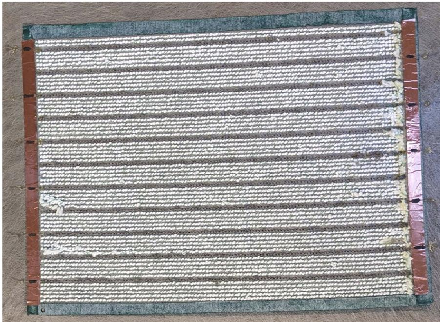
Abbildung 30: Rückenansicht eines Filters inkl. Kupferstreifen und Kontaktierung der leitfähigen Garne
