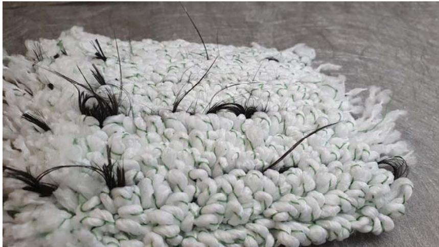
Abbildung 4: Tuftmuster mit Carbongarn und gebrochenen Filamenten auf der Polseite
