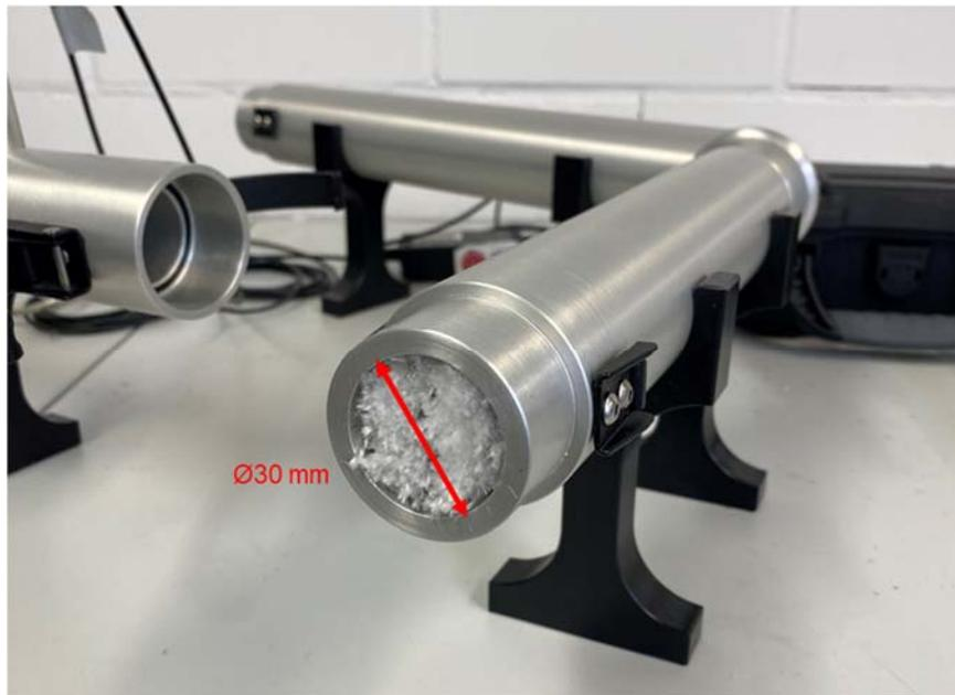
Abbildung 13: Fotografie des Impedanzrohrs mit eingebauter Filterprobe
