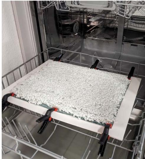
Abbildung 36: Platzierung des Filters mit Rahmen in der Spülmaschine
