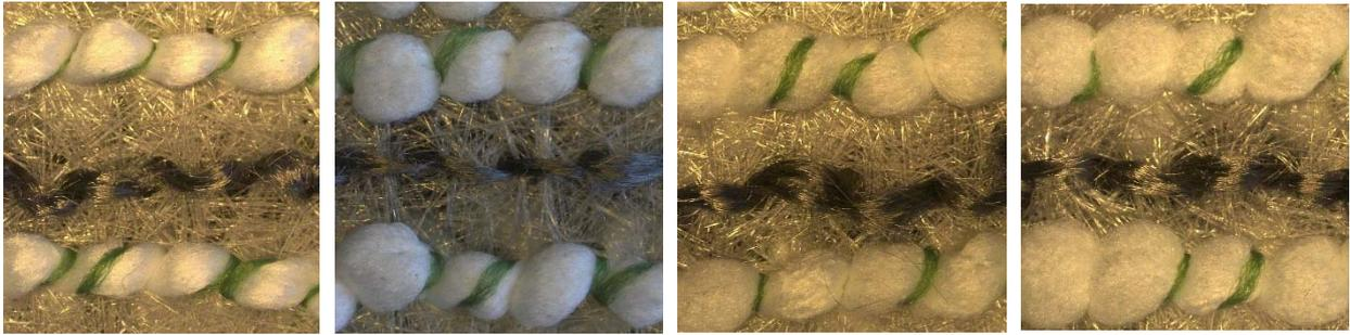
Abbildung 53: Digitalmikroskopische Aufnahmen des rückseitigen Polgarns; von links nach rechts: vor dem Waschen, Probe 1, Probe 2, Probe 3
