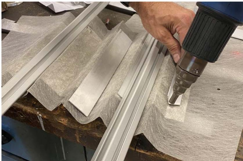
**Abbildung 32: Thermoformprozess zur Plissierung mit Heißluft**
