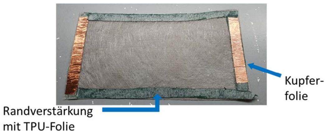
Abbildung 27: Randverstärkter Filter
