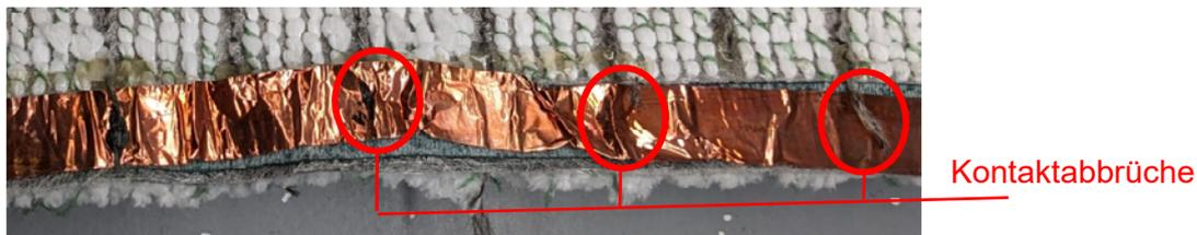
Abbildung 51: Probe 3; Nahaufnahme der Kontaktabbrüche
