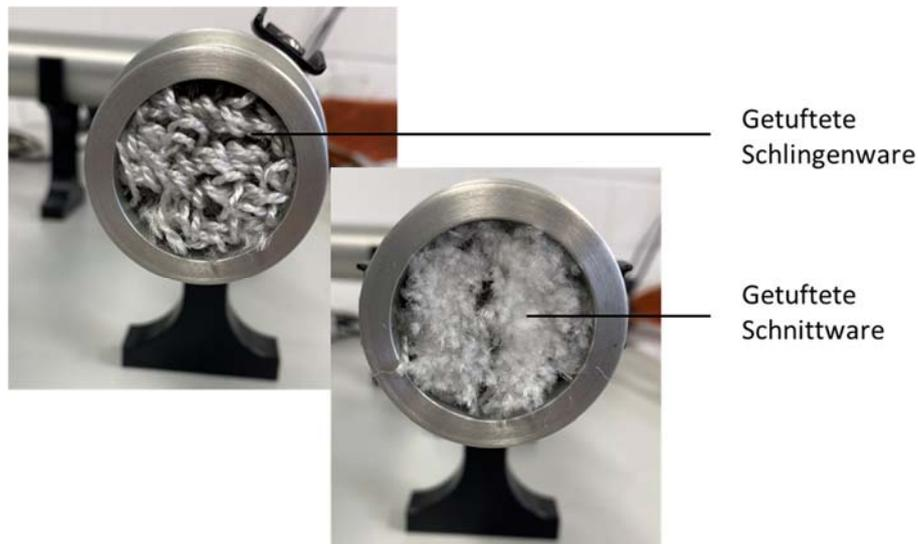
Abbildung 14: Impedanzrohr mit eingebauter Schlingen- bzw. Schnittpolprobe
