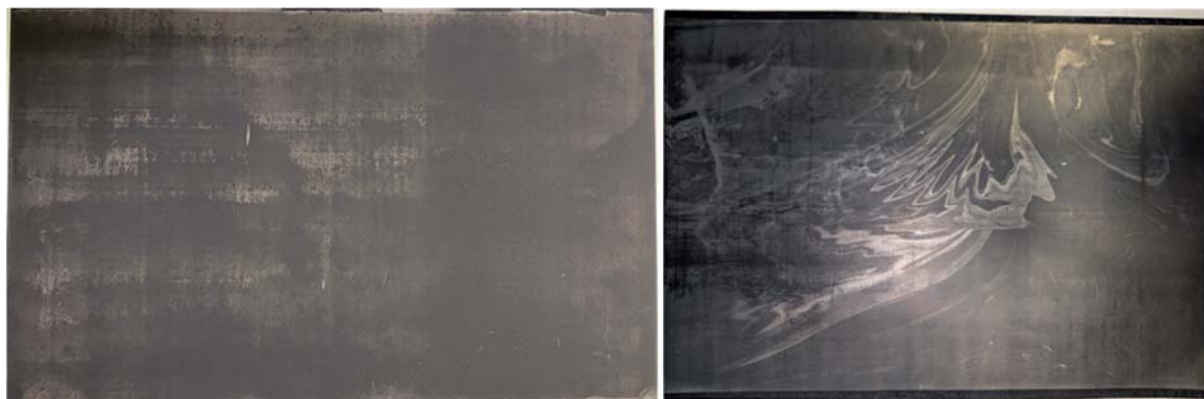
Abbildung 2.16: Pt-Abscheidung im DIN A4-Format mit Strompulsen (links) und Gleichspannung (rechts)
