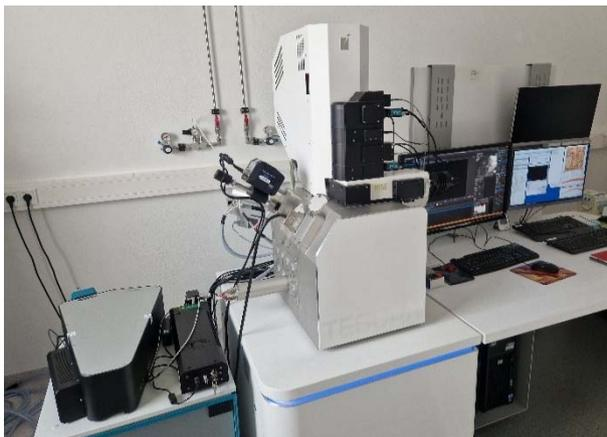
Abbildung 29. Foto des RAMAN/REM-Mikroskop des IUTA (Witec RISE, Tescan CLARA).
