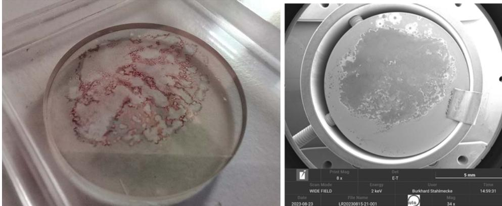
Abbildung 64 Foto und REM-Aufnahme eines mit C16-TES TXRF-Plättchens nach Goldbedampfung
