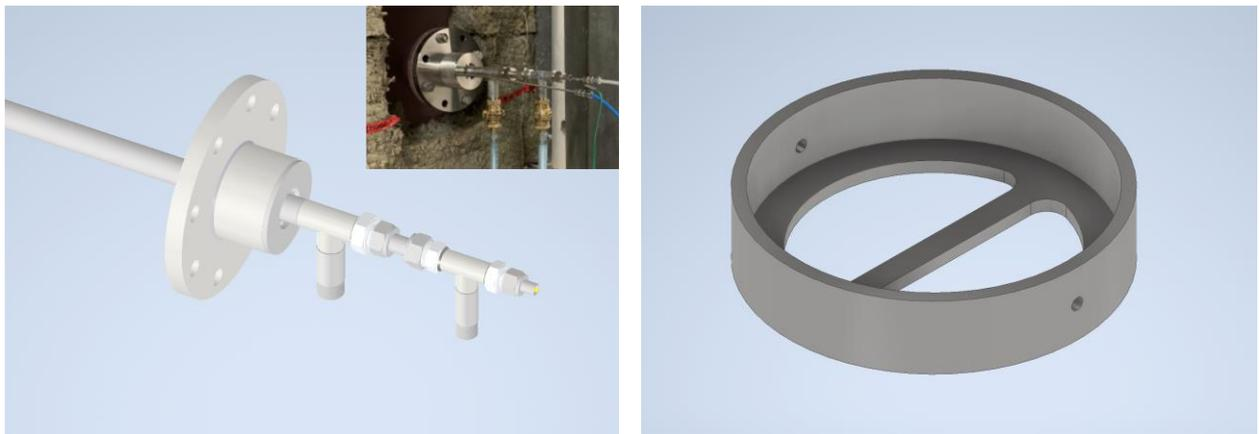
Abbildung 9: Optimierte Fixierung der Probennahmelanze und Foto des eingebauten Zustands am Kessel (links) sowie die neu entwickelte Substrathalterung für die Quarzfaserfilter (rechts).
