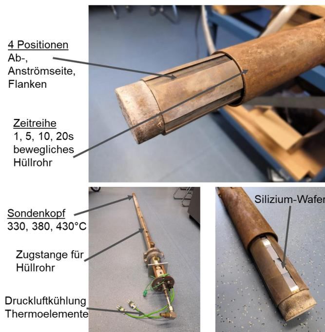
Abbildung 12: Probennahmesonde der Universität Augsburg zur Untersuchung deponierter Partikel
