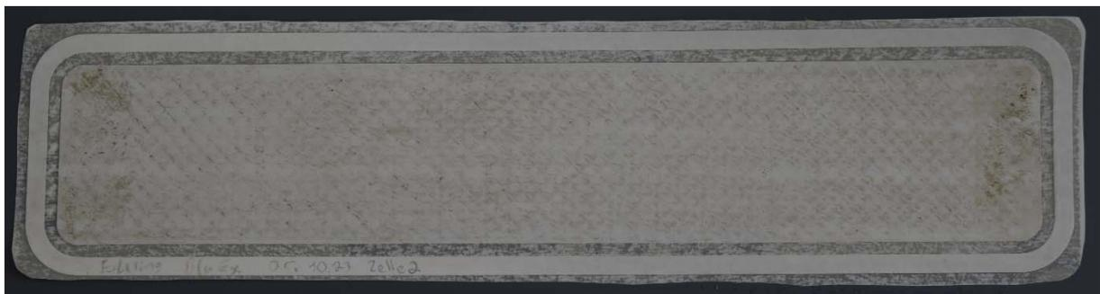
*Abbildung 35. Membranprobe nach Foulingversuch mit Blumenerde-Extrakt*
