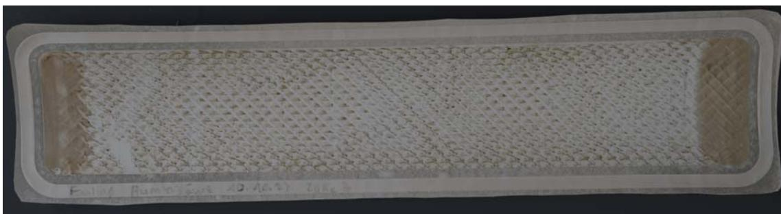
*Abbildung 30. Membranprobe nach Foulingversuch mit Huminsäure*
