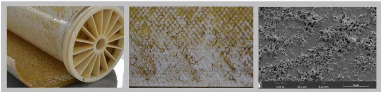
*Abbildung 19. Beispiel für durch hohen Organik- und Algenanteil im Wasser entstandenes Fouling*
