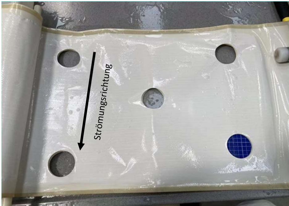
Abb. 14: Modifiziertes und autopsiertes Modul mit gekennzeichnete Strömungsrichtung
