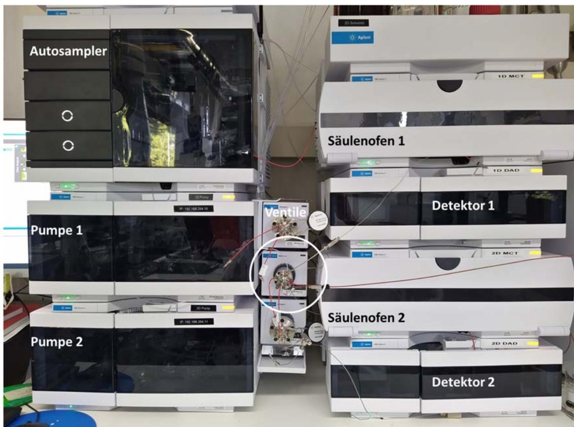
Abbildung 4: Foto des Gesamtaufbaus der Säulenschaltung mit Beschriftung der Module. Der weiße Kreis stellt den Bereich dar, der in Abbildung 5 noch einmal vergrößert aufgenommen wurde.
