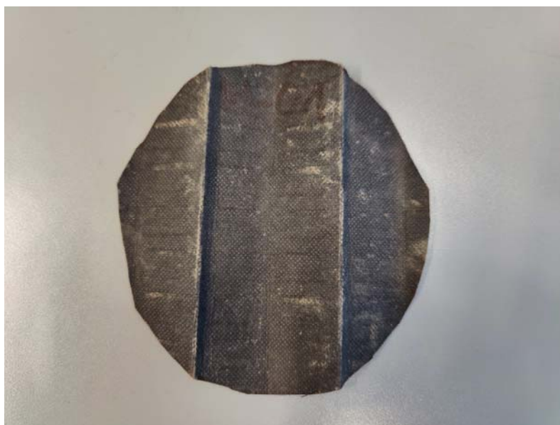
Abbildung 4-32: Aus der Filterpatrone herausgeschnittene, glattgedrückte Ronde zur Messung am Filtermedienprüfstand
