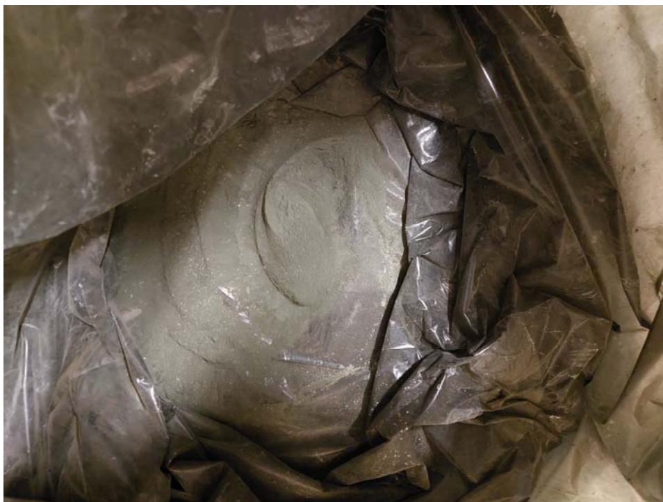
Abbildung 4-35: Durch den Transport abgeplatzter Filterkuchen
