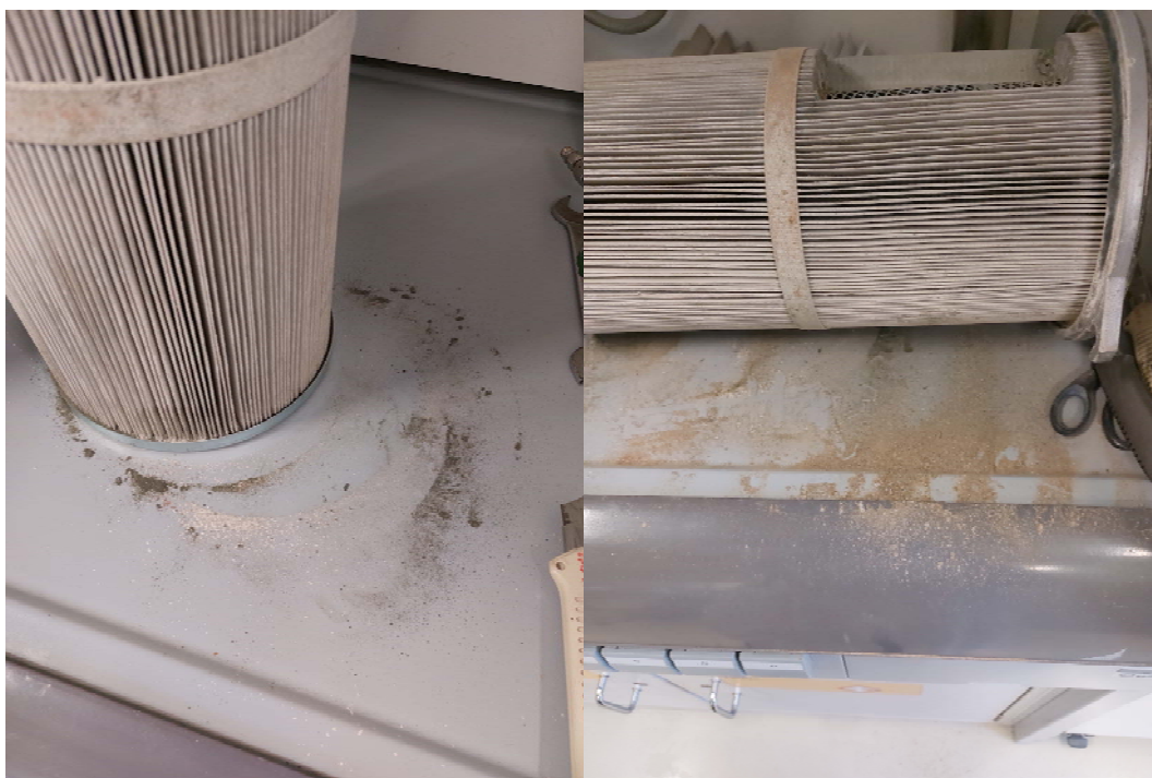
Abbildung 4-36: Durch das Abstellen der Filterpatrone abgelöster Staub (links) und durch das Herausschneiden des Filtermediums aus der Filterpatrone abgelöster Staub (rechts)
