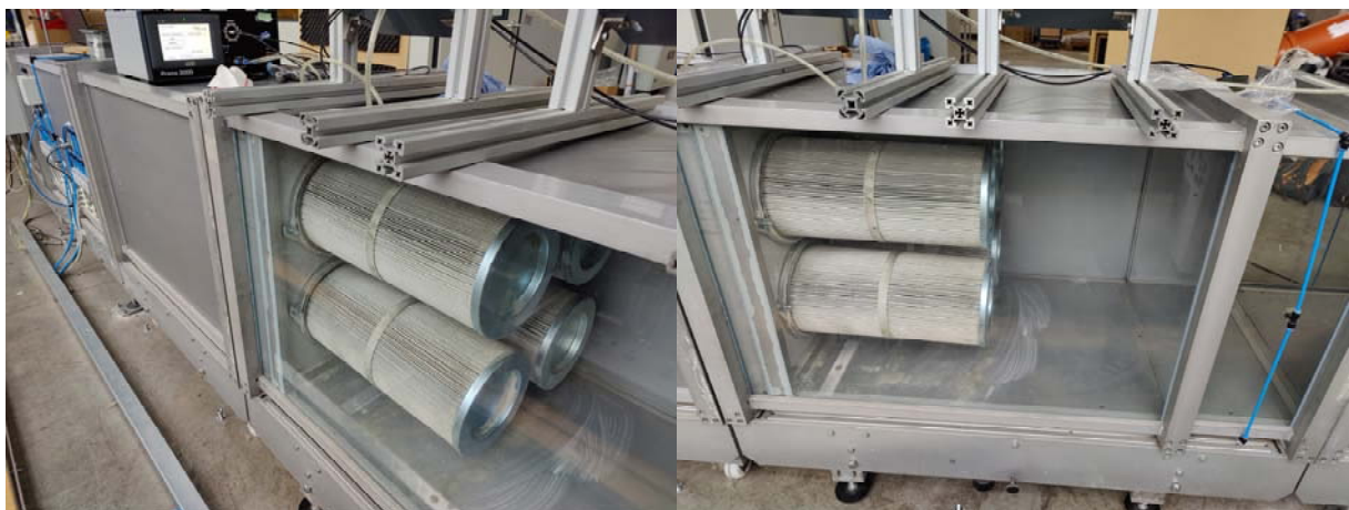
Abbildung 4-21: Prüfstand nach EN 779 mit eingebauten Filterpatronen
