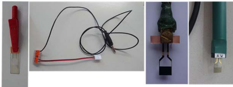
Abbildung 31: Kontaktierung- Einsatz diverser Halterungen (u.a. Cu-Klebeband, Adapter, Halterung mit Federkontakten)
