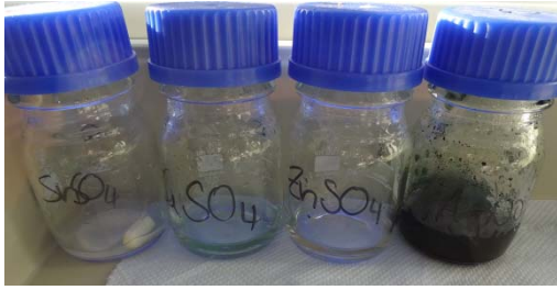
Abbildung 39: 0,5M Anilinlösung mit Metallsalzen (Zinn-, Zink- und Kupfersulfat); Zinnsulfat löst sich nicht, Kupfersulfat leicht bläulich, Zinksulfat klare Lösung
