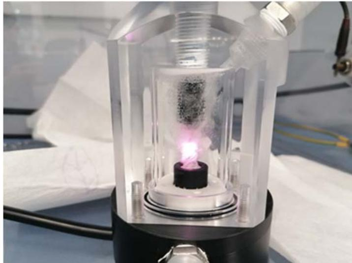
Abb. 3: Plasmaentladung im Wasser-Argon-Gemisch im wässrigen Präkursor durch eine gepulste Hochspannung und einer Wirbelströmung des Wassers
