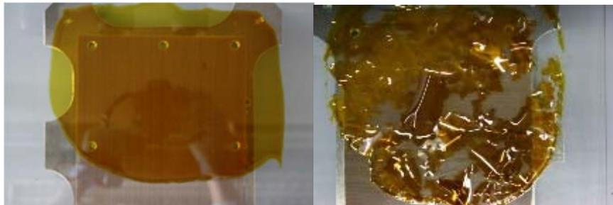
Abb. 7: Membranherstellung der quaternisierten Blockcopolymeren: links ist die Nassschicht abgebildet und rechts die Membranschicht nach dem Trocknen.
