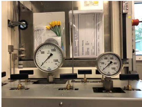
Abbildung 4: Fotos des entwickelten Aufbaus für H 2 -Permeationsmessungen.
