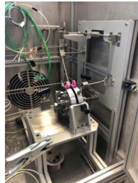
Abbildung 4: Fotos des entwickelten Aufbaus für H 2 -Permeationsmessungen.
