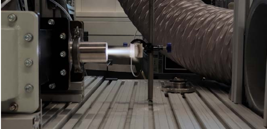
Abbildung 4: Behandlung einer Aluminiumprobe mittels druckluftbetriebenen Mikrowellenplasmajets
